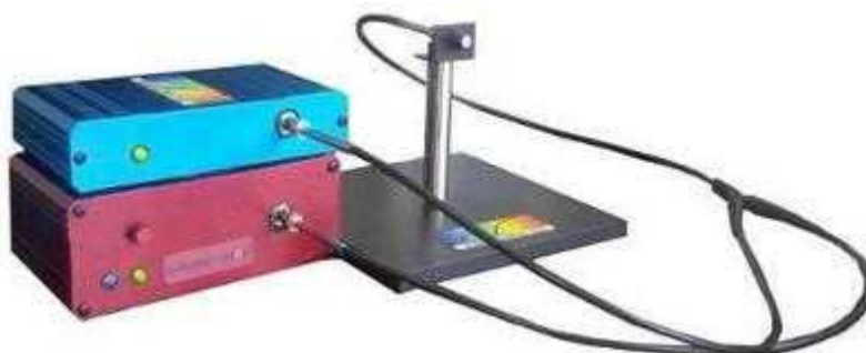
Slika 3.2 Prikaz StellarNet spektrografa sa odgovarajućim optičkim kablovima
