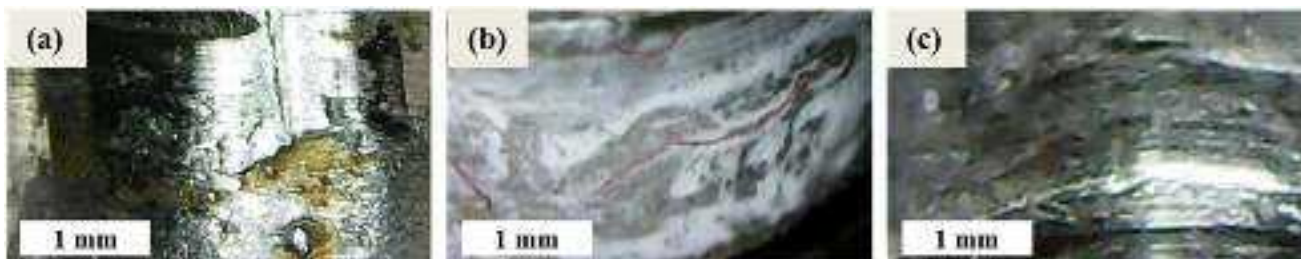
Slika 4.4.10 Slike unutrašnjih površina otvora superlegure Nimonik 263: a) netretiranog uzorka; b) uzorka tretiranog pikosekundnim laserskim zračenjem; c) uzorka tretiranog nanosekundnim laserskim zračenjem [134]
