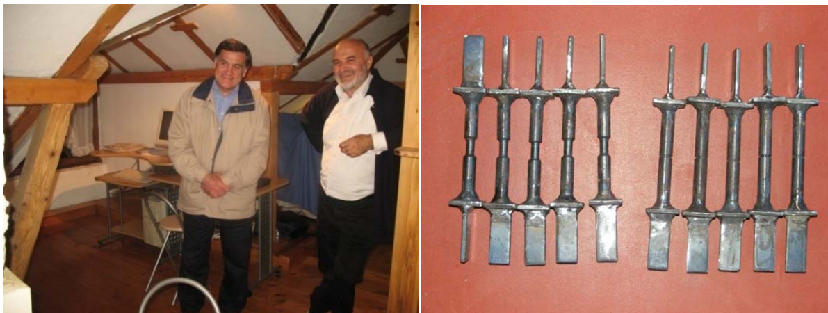
Сл. 124 Иновациони Центар ДЦ 90 у Добри, Сл. 125 Серија узорака тестирана на замор
