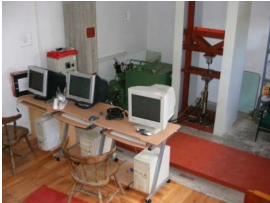
Сл. 61 Вибро платформа и актуатор са управљачким и електрохидрауличким системом.
