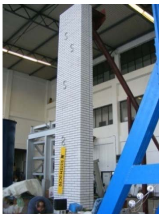
Сл. 101 Модел у размери 1:3 са уграђеним моделима дампера-конектора типа Kanada HQL пре тестирања на виброплатформи, и Сл. 102. Фреквентна крива доминантних фреквенција добијених програмом ATREMIS
