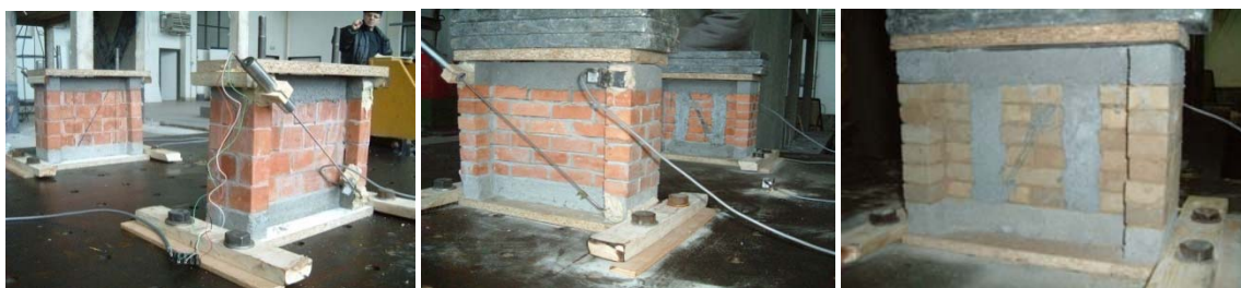
Сл. 86 Модели на виброплатформи од шупље опеке (лево), од пуне опеке (средина) и од непечене опеке (десно)
