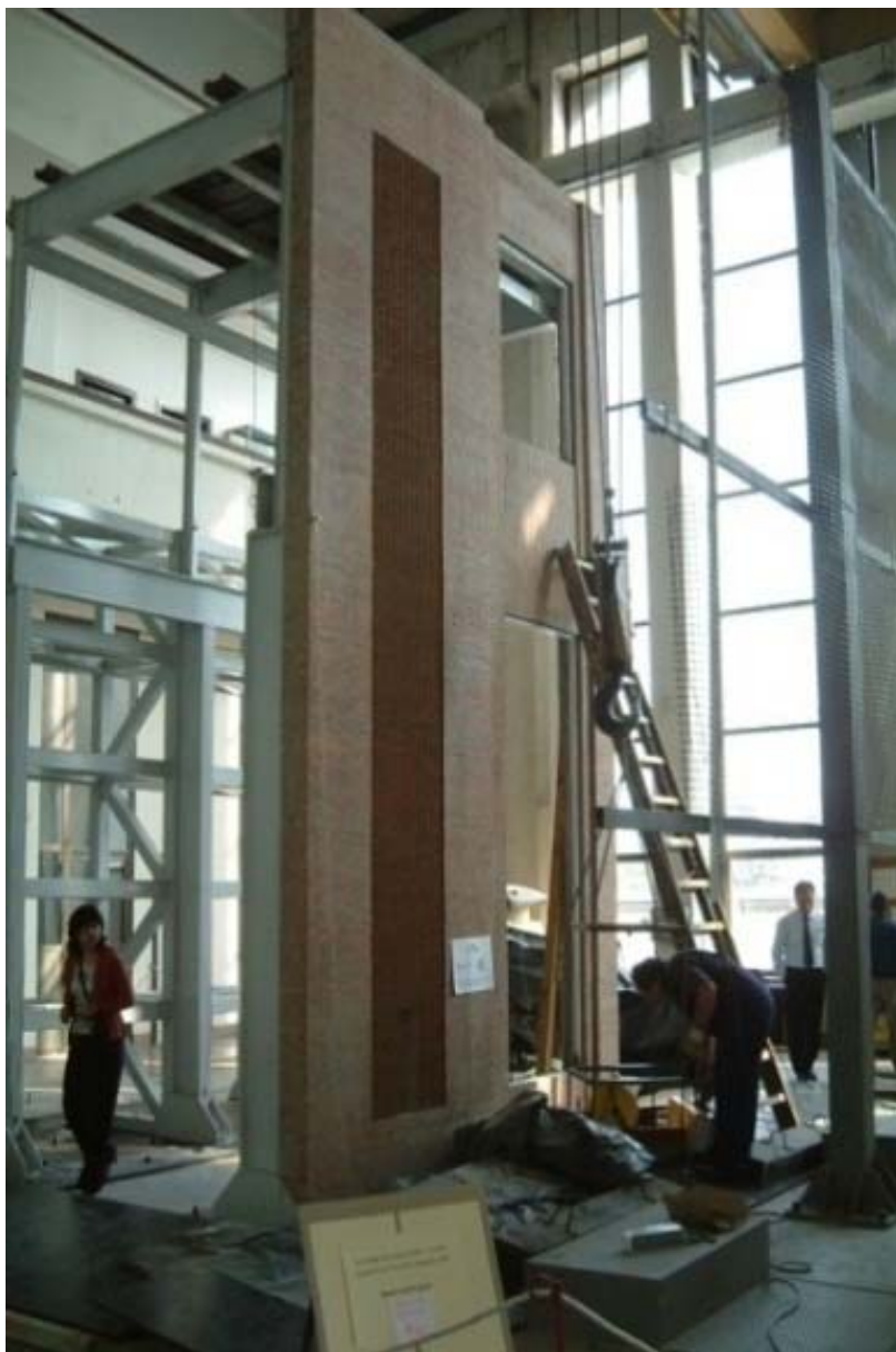
Сл. 128 Модел зида хидроелектране "Веаиһапоис"-Канада у размери 1:3 на вибро-платформи ИЗИИС-а у Скопљу.
