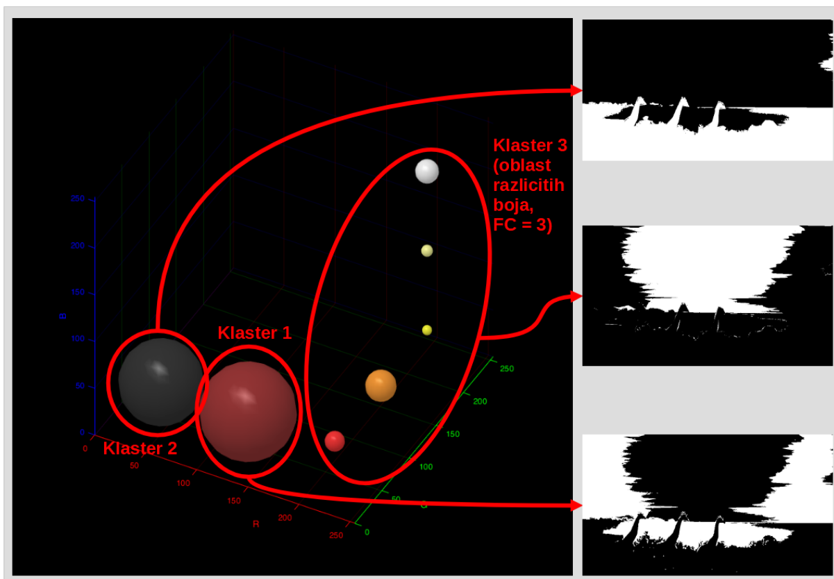
Slika 12. Primer rada predloženog algoritma na realnoj slici za tip2 obradu - Klasterizacija piksela prikazana u 3D RGB prostoru za DC=2 , FC=3 , kao i odgovarajući crno-beli produkti (za nosilac sa slike 10)
