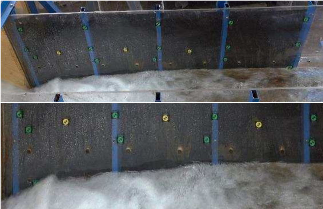
Slika 15. Gore: originalna slika iz video zapisa za merenje dubina u kanalu; Dole: ortorektifikovani prikaz originalne slike.
