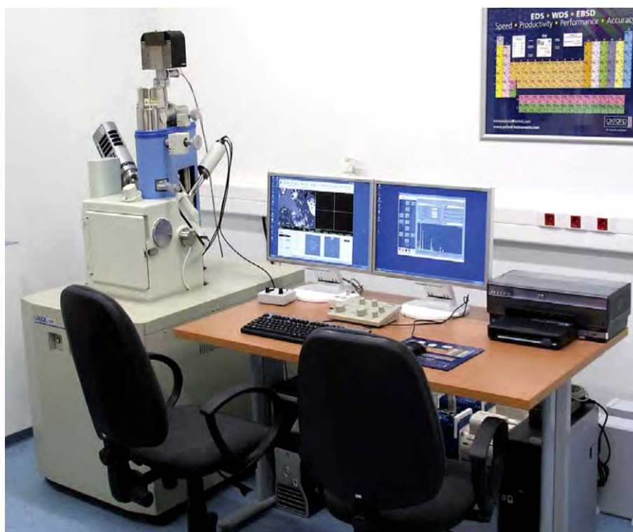
Слика 9. Скенирајући електронски микроскоп, модел JEOL JSM-6460.
