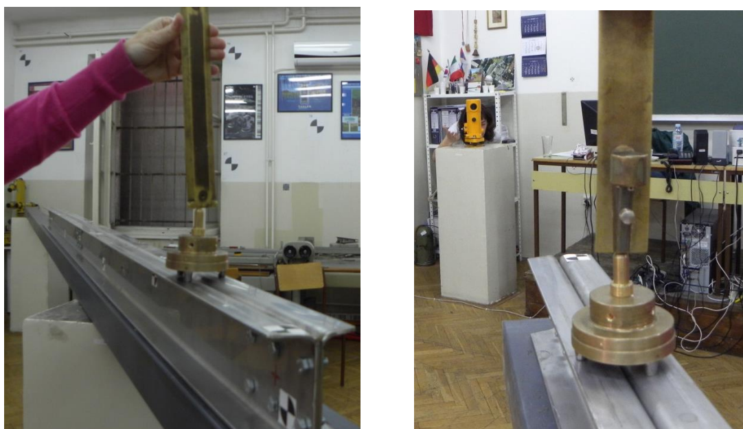
Slika 3.32 Merenje geometrijskih imperfekcija uzoraka
