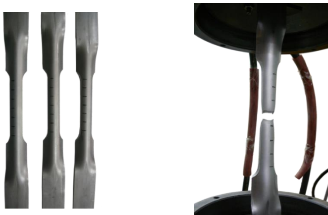
Slika 3.14 Ispitivanje epruveta iz ugla hladnooblikovanog profila pri zatezanju
