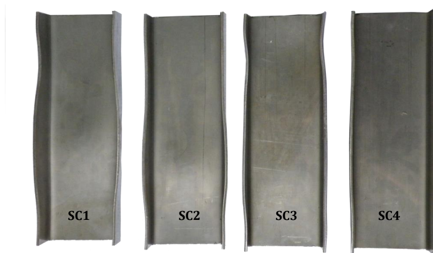
Slika 3.21 Deformisani oblik uzoraka nakon ispitivanja na pritisak
