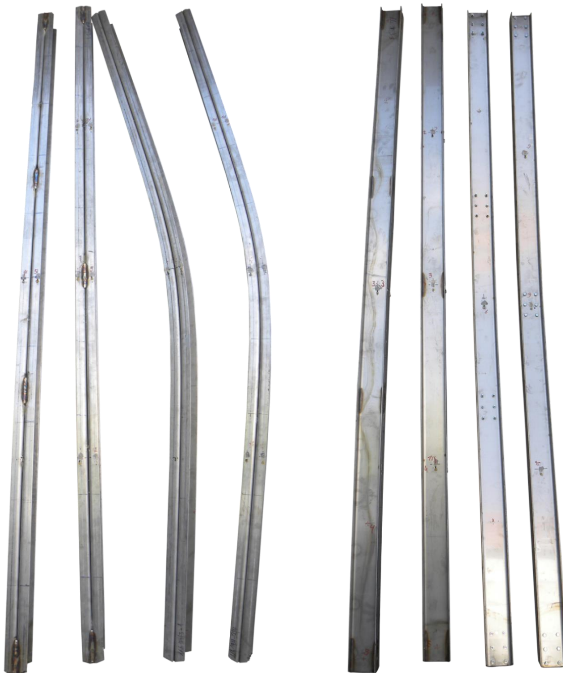
Slika 3.62 Deformisani oblik uzoraka serije U184 nakon ispitivanja
