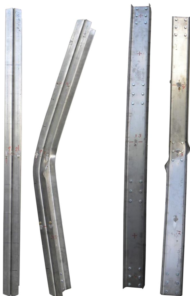
Slika 3.40 Deformisani oblici uzoraka grupe U92b nakon ispitivanja
