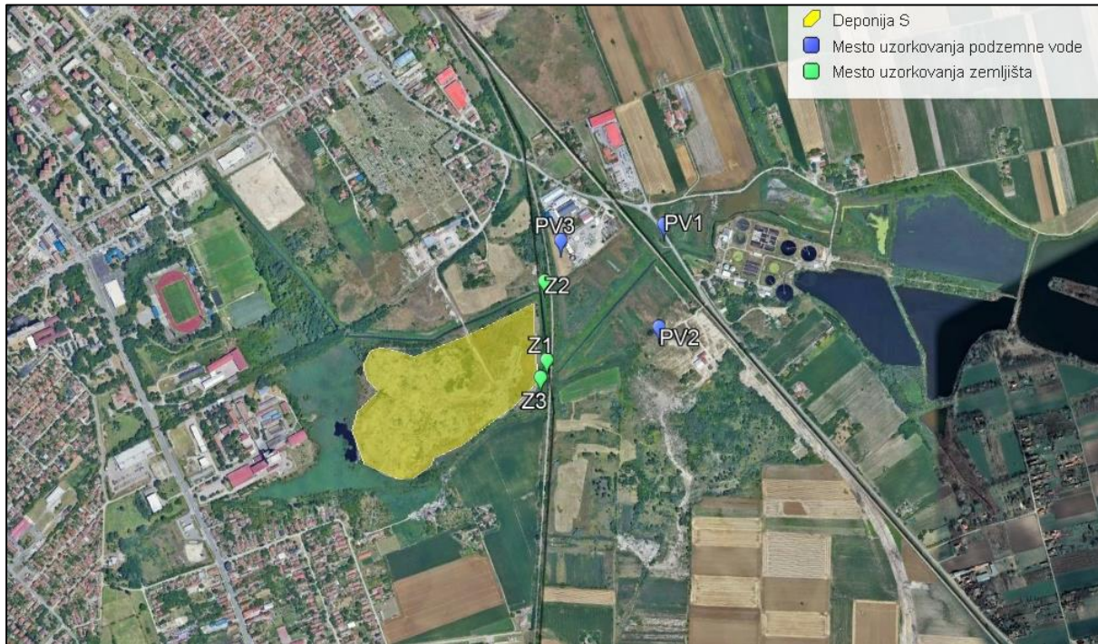
Slika 38. Mikrolokacija deponije S kod Subotice sa naznačenim mestima uzorkovanja podzemne vode i zemljišta
