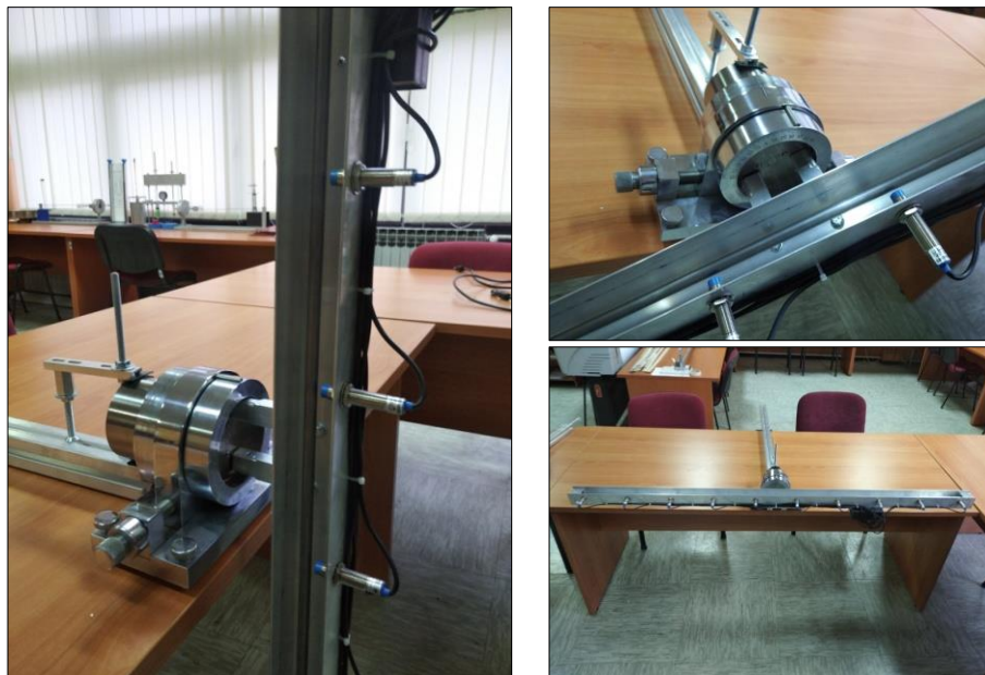
Слика 2.2.14 Фотографски прикази модула намењеног истраживањима у области кинематског трења, надграђеног на основну конфигурацију уређаја [48].
