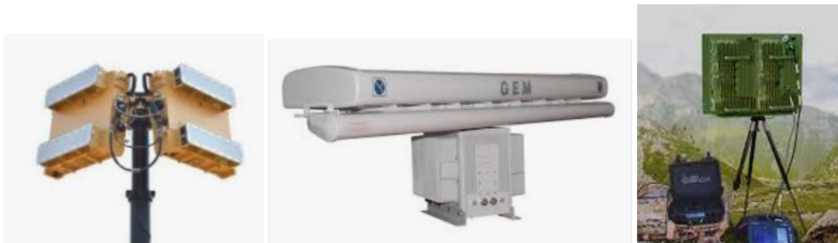
Slika 2. Razliciti tipovi radara: a) sa skaniranim antenskim nizom bez pomerajucih delova za zastitu granice, b) sa rotirajucom antenom tipicno za osmatranje mora i vazdua, c) pesadijski radar za rad sa tronosca
