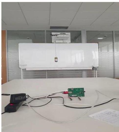
Slika 56. Postavka i rezultat laboratorijskog eksperimenta praćenja pokretne mete preko FMCW radara i vVSP platforme
