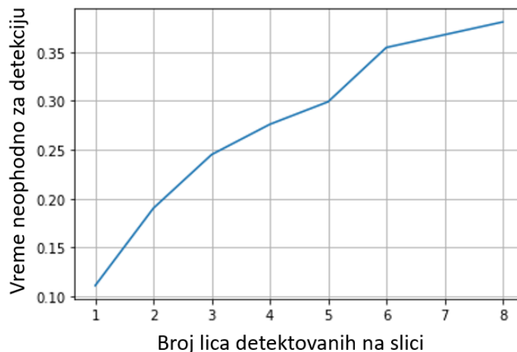
Slika 51. Prosečno vreme potrebno za otkrivanje svih lica prema broju lica otkrivenih na slici. Testirano na RTX 2060
