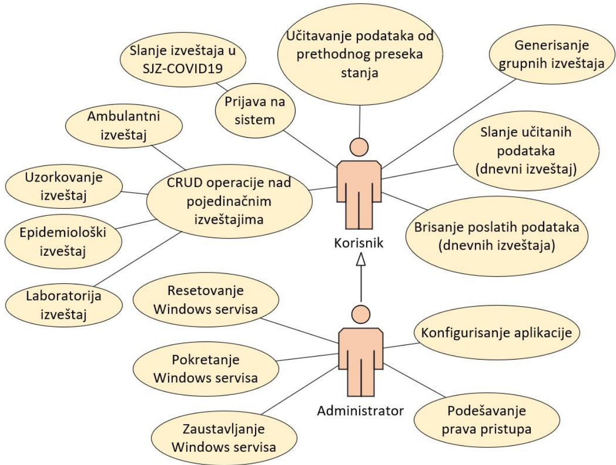
SLIKA 60. Dijagram slučajeva korišćenja razvijenog modula MEDIS.NET-a za kolaboraciju sa centralnim servisom SJZ-COVID19
