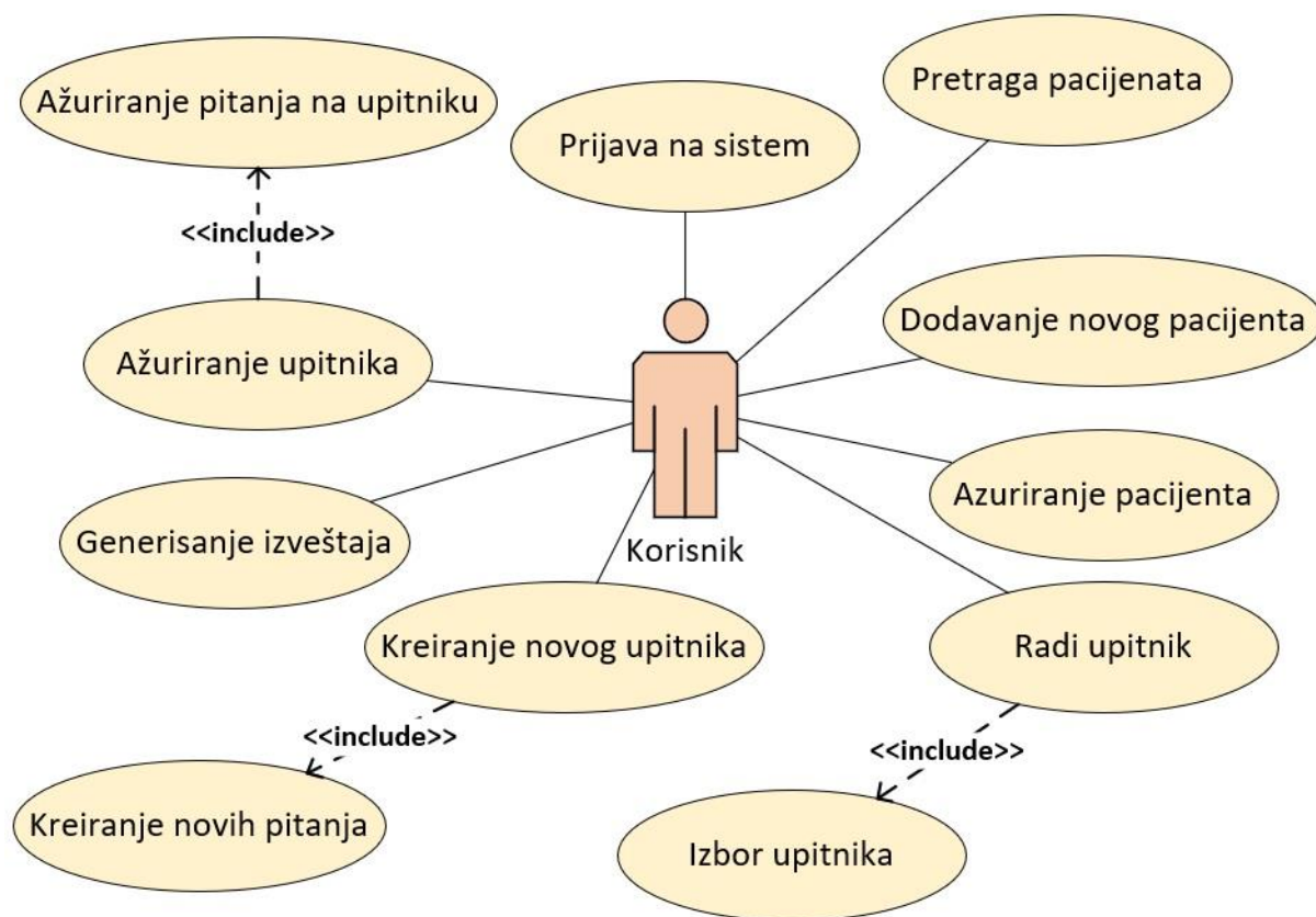
SLIKA 37. Dijagram slučajeva korišćenja Alata za generisanje dinamičkih upitnika
