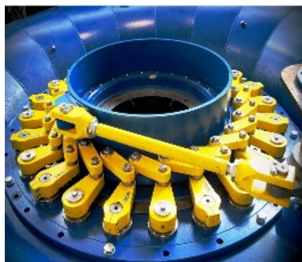
Slika 5.7. Šema zakretanja lopatica sprovednog kola delovanjem servomotora na prsten
