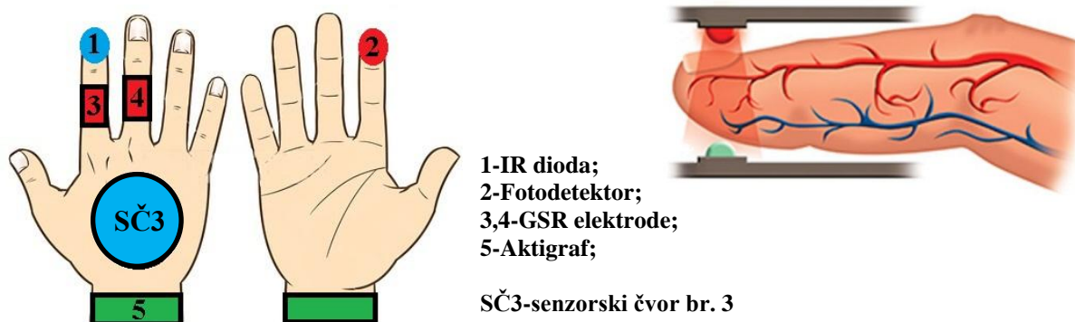
Slika br.18 Šematski raspored elektroda i senzorskog čvora u balističkoj rukavici
