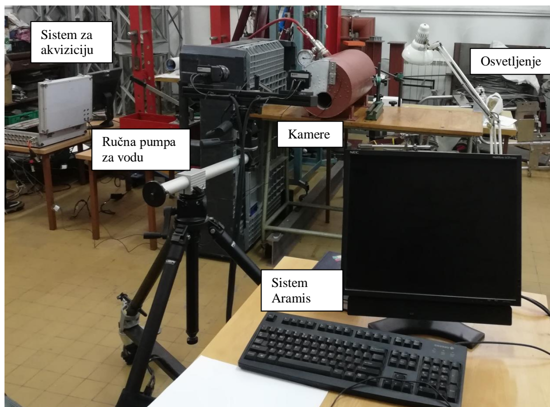
Slika 5.23 - Dispozicija merne opreme
