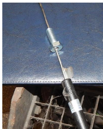
Slika 6.6 - Izvođenje vijka za bezbedno postavljanje mernih sondi
