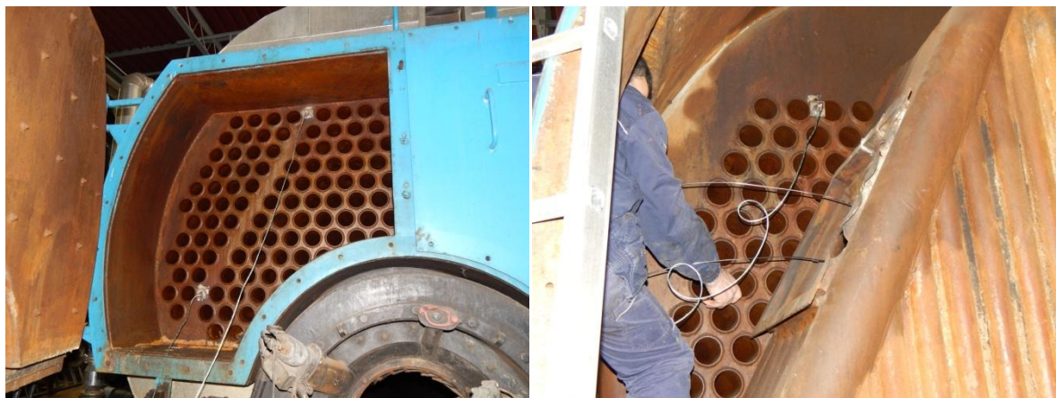
Slika 6.8 - Postavljanje temperaturskih sondi
