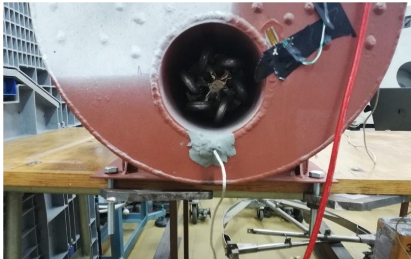
Slika 5.28 - Fiksiranje oslonaca modela za postolje
