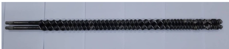
Slika 16. Izgled pužnica primenjenih tokom procesa ekstrudiranja
