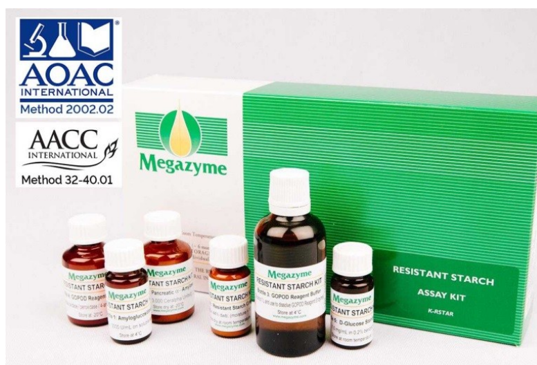
Slika 26. Megazyme kit za određivanje sadržaja RS ( https://www.megazyme.com/resistant-starch-assay-kit )
