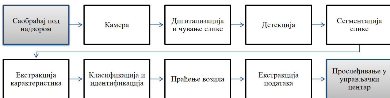
Слика 3.22. Концепт обраде слике за потребе детекције, класификације и праћења возила (извор: Mimbella и Klein, 2007 ).
