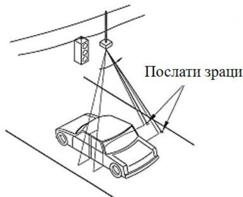
Слика 3.15. Послати сигнали активног инфрацрвеног сензора (извор: Mimbela и Klein , 2007).
