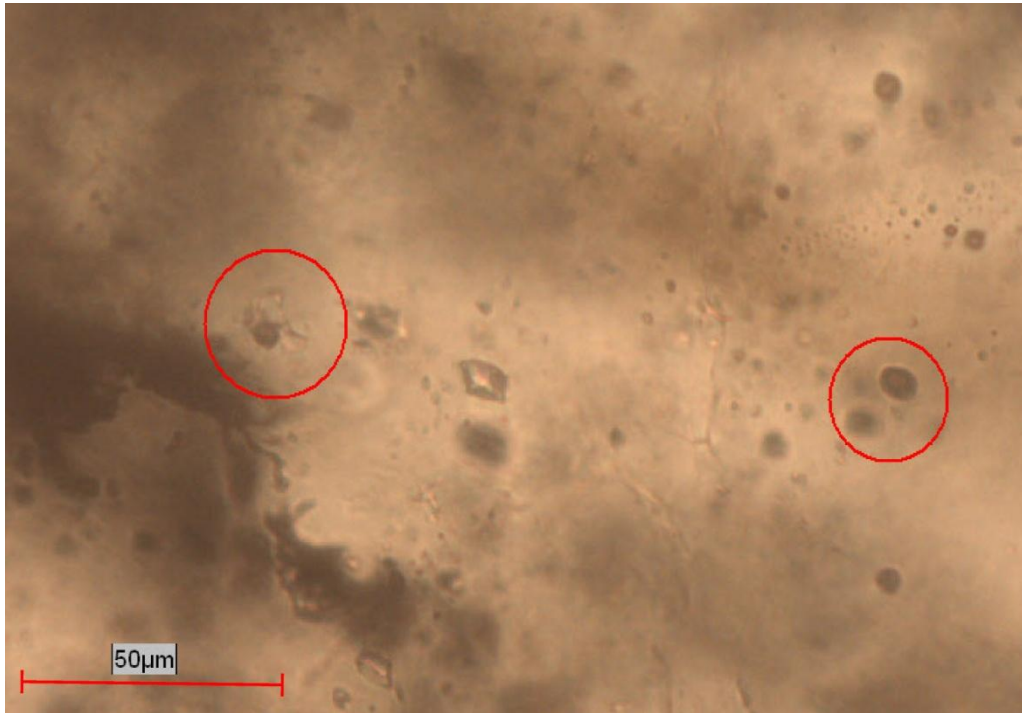
Слика 89-4: Инклузије са кристалима соли (вероватно тип 3) и мале инклузије богате паром (тип 4) у истом зрну у кварцу, пропуштена светлост.
