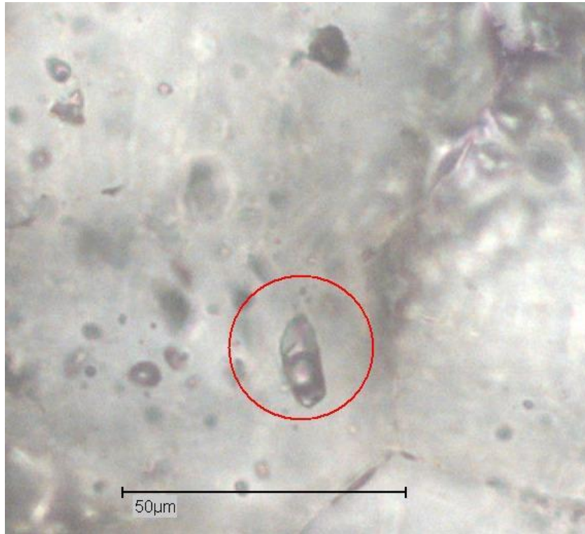
Слика 121-1: Крупна инклузија богата паром (тип 4) у кварцу, пропуштена светлост.
