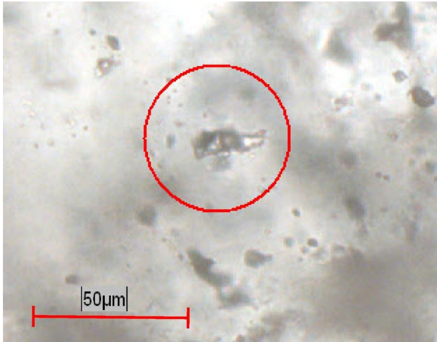
Слика 116-6: Полифазне инклузије са 2 кристала соли и непровидним минералом (тип 2а) у кварцу, пропуштена светлост.
