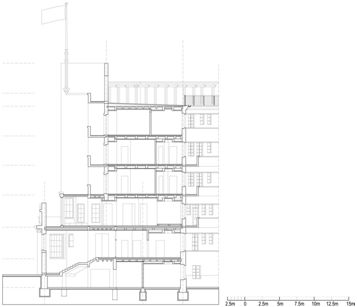
Слика 3.1.16 Зграда Првог дунавског багерско-паробродарског друштва, пресек кроз улазни хол / архитекти: Александар Поп, инж. Стеван Тоболар, 1924. Извор: Документација Историјског архива Београда, сигнатура бр. 10-14-24, АСАД цртеж ВП, мај 2012.
