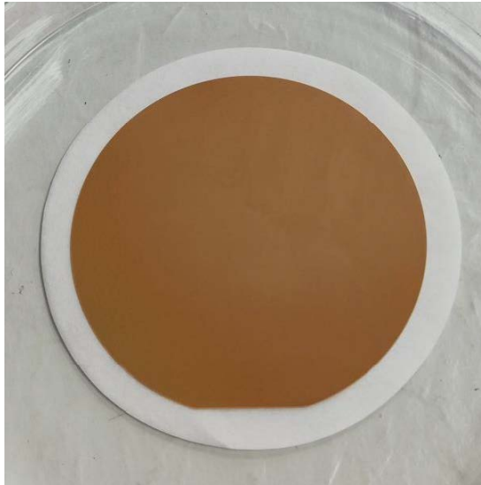
Slika 7.1.5. Pyrex staklo sa slojem Au i podslojem Cr.
