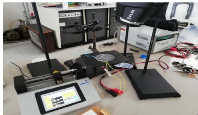
Slika 7.2.8. Eksperimentalna postavka za merenja temperature integrisanih grejača na mikoreaktoru od Si-Pyrex stakla
