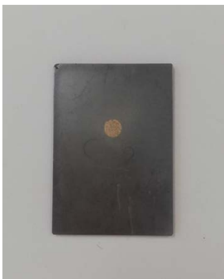
Slika 7.5.11. Uzorak nakon odgrevanja u na silicijumskom nosaču pre snimanja na uređaju za rendgensku strukturnu analizu
