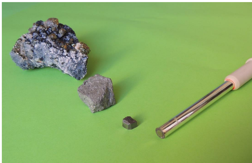
Слика 2.1 Природни минерал пирит, форме пирита у процесу његове лабораторијске обраде и финални изглед пиритне електроде коришћене у раду.
