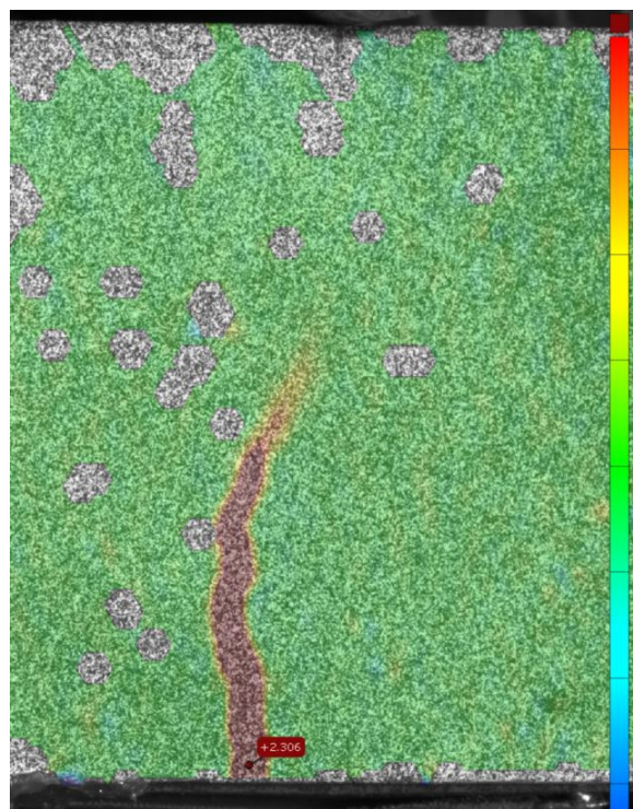
Slika 5.33 Test zamora - Prslina u gredi pred lom dobijena fotogramterijom
