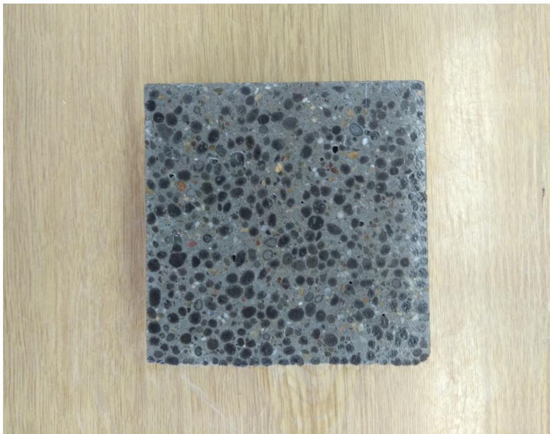
Slika 8.5 Uzorak lakoagregatnog betona sa ternarnim sistemom veziva C-Z-P
