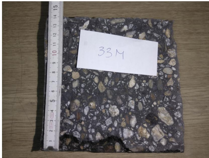
Slika 5.21 Ispitivanje prodora vode pod pritiskom uzorka sa 30% m/m mehanički aktiviranim pepelom OP TE Morava 240, w/b=0,3
