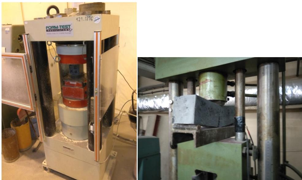
Slika 3.6 Ispitivanje čvrstoće pri pritisku i pri zatezaju savijanjem
