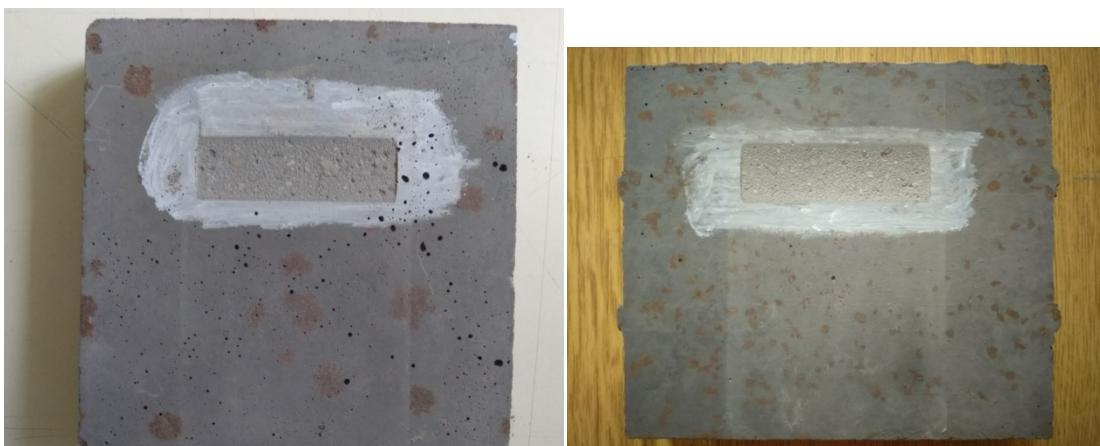
Slika 6.15 Uzorci ZBVPP pravljeni sa vodom 3,8% i 11,4% saliniteta nakon ispitivanja otpornosti na habanje
