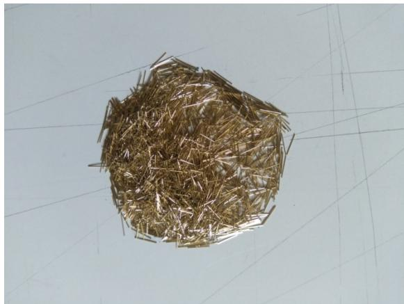
Slika 3.1 Čelična mikrovlakna Spaić
