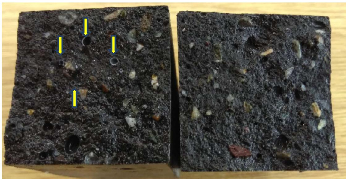
Slika 6.9 Uzorak levo - izluživanje u ponekim porama EM45-1C, uzorak desno - bez izluživanja u porama EM45-3C nakon 365 dana u vodi
