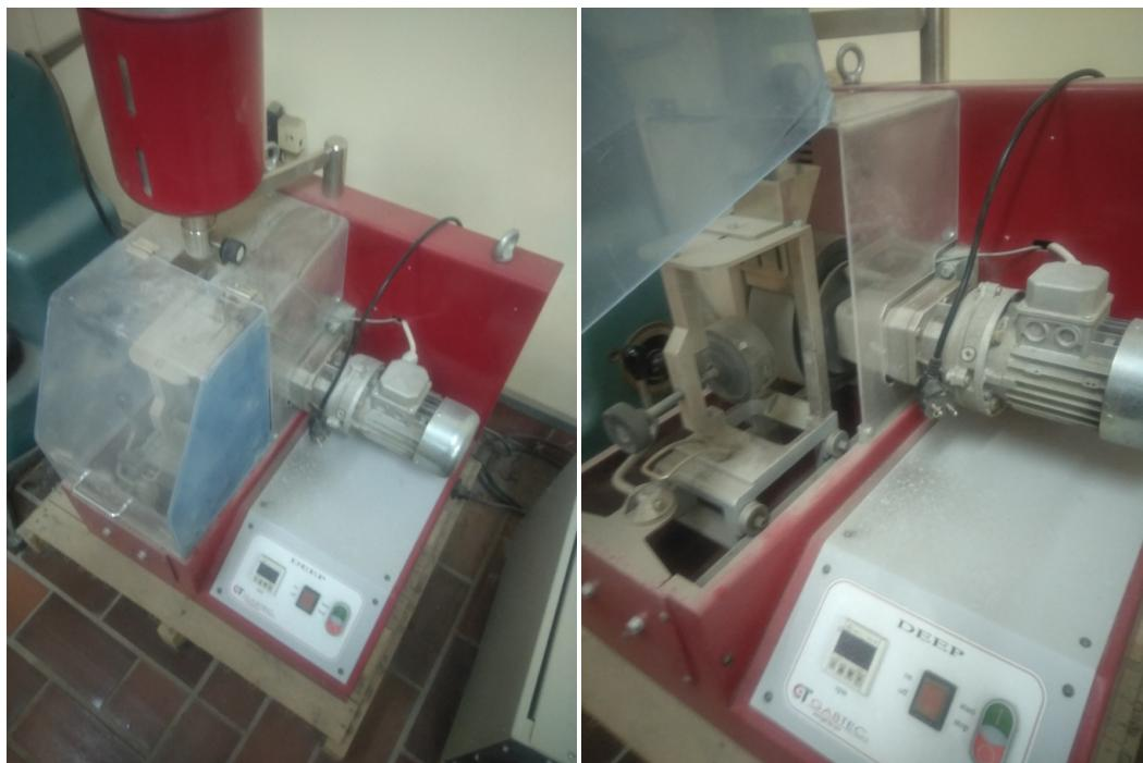
Slika 3.4 Ispitivanje otpornosti na habanje pomoću Kaponove metode
