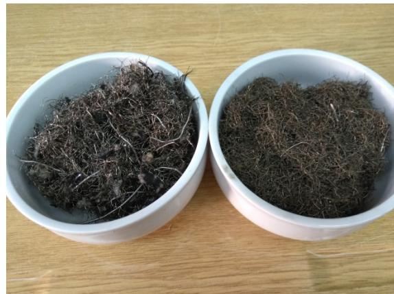
Slika 3.2 Reciklirana čelična vlakna dobijena (levo) i prosejana (desno)
