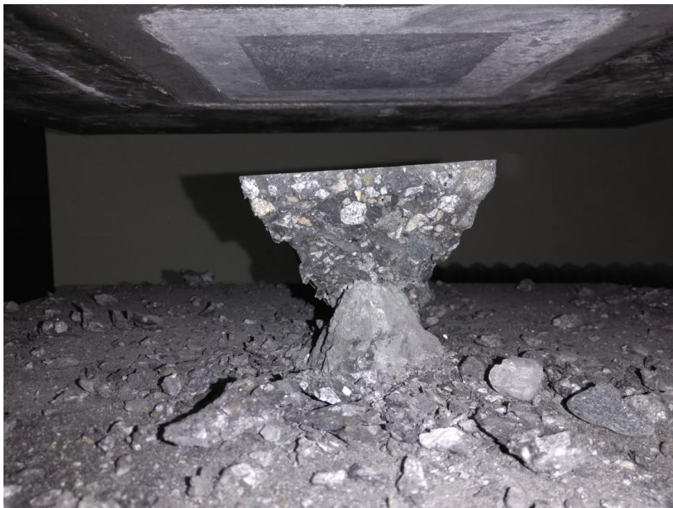
Slika 5.6 Polomljen uzorak ZBVPP sa 30 % m/m OP TE Morava-240 i  $w/b=0,167$  nakon ispitivanja čvrstoće pri pritisku
