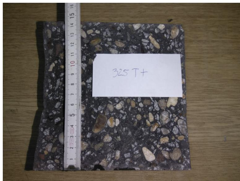
Slika 5.23 Ispitivanje prodora vode pod pritiskom uzorka sa 30% m/m mehanički aktiviranim LP TENTB-240, w/b=0,25
