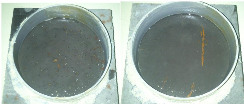
Slika 6.17 Uzorci ZBVPP pravljeni sa običnom vodom (levo) i slanom vodom (desno) nakon ispitivanja otpornosti na mraz
