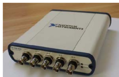
Slika 6.5 Oprema korišćena za eksperimentalnu modalnu analizu: a) Senzor ubrzanja PCB 352C33 b) A/D kartica National Instruments USB-4432
