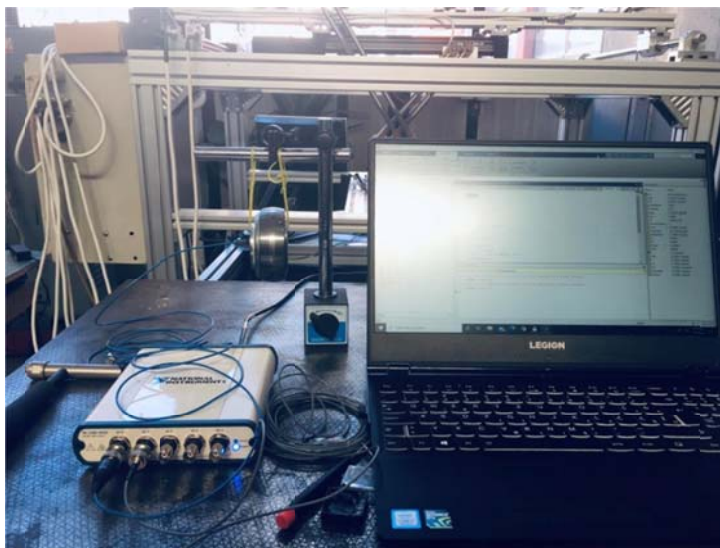
Slika 6.12 Postavka eksperimentalne modalne analize ležaja LSQFR 308
