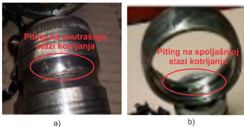
Slika 6.40 Izgled oštećenih ležaja nakon ispitivanja a) G_r = 10 \mu\text{m} b) 40 \mu\text{m}
