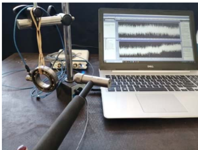
Slika 6.7 Procedura eksperimentalne modalne analize ležaja 6006
