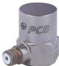
Slika 6.5 Oprema korišćena za eksperimentalnu modalnu analizu: a) Senzor ubrzanja PCB 352C33 b) A/D kartica National Instruments USB-4432
