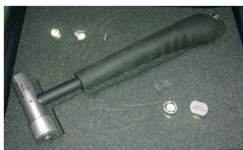
Slika 6.4 Pobudni čekić: a) izgled; b) dimenzije
