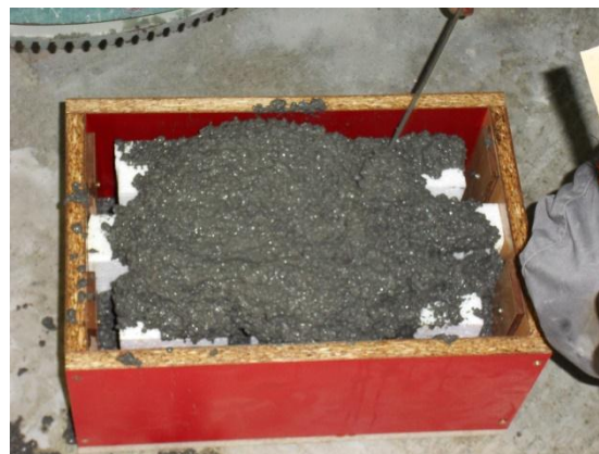
Slika V-41. Ugrađivanje betona u kalupe za betonske blokove za zidanje
