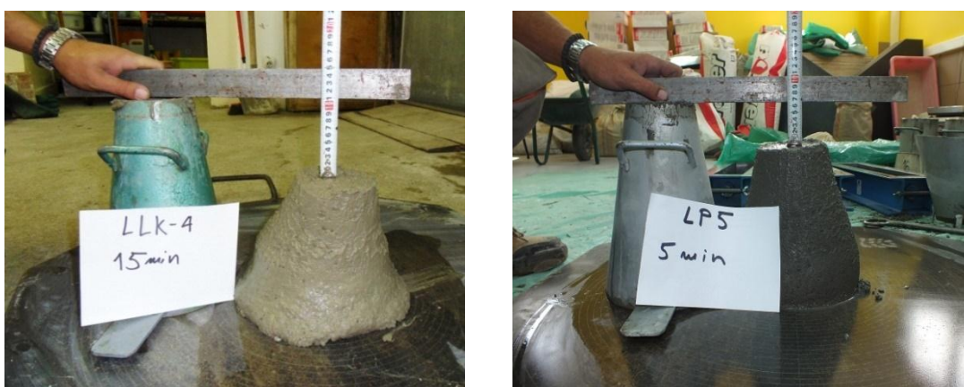
Slika V-43. Merenje konzistencije metodom sleganja za betone LLK-4 i LP-5
