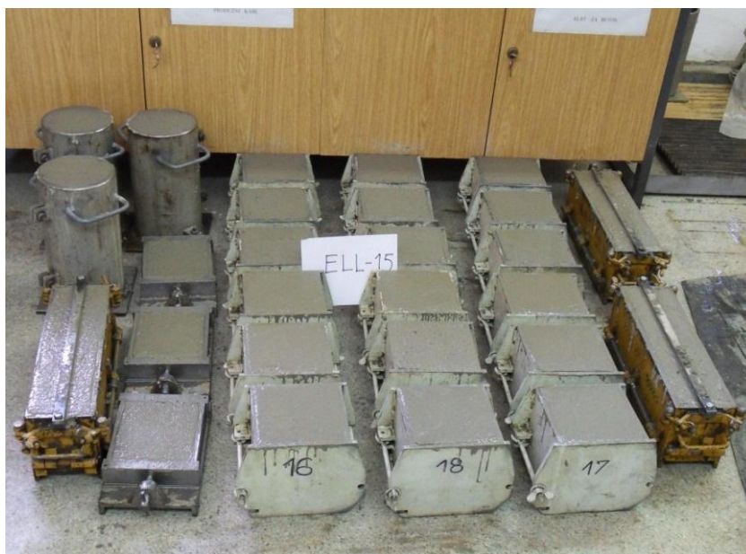
Slika V-40. Beton ugrađen u kalupe
