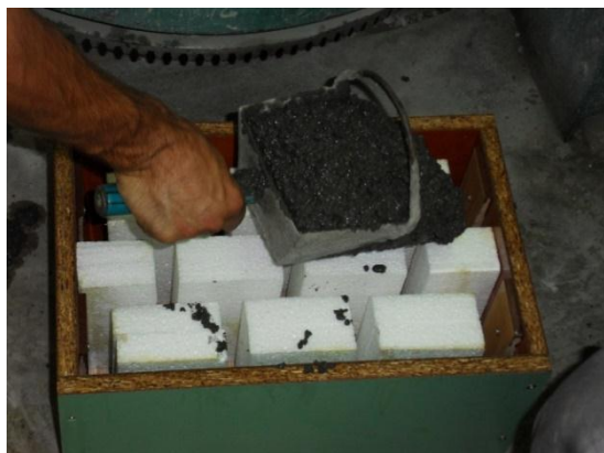
Slika V-41. Ugrađivanje betona u kalupe za betonske blokove za zidanje
