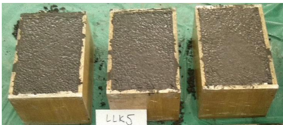
Slika V-42. Betonski blokovi ugrađeni u kalupe
