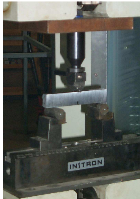
Slika 5.13. Izgled postupka ispitivanja SEB epruvete.
