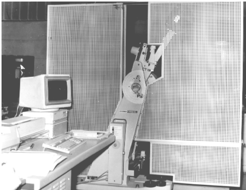
Slika 5.9. Instrumentirano Šarpi klatno SCHENCK TREBELL 150/300 J.
