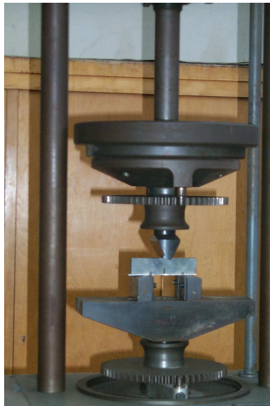
Slika 5.10. Stvaranje zamorne prsline na visokofrekventnom pulzatoru kod SEB epruvete.
