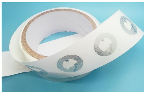
Slika 7.19. Izgled upotrebljenog pasivnog NFC taga – NTAG 213 (Izvor: NXP Semiconductor)
