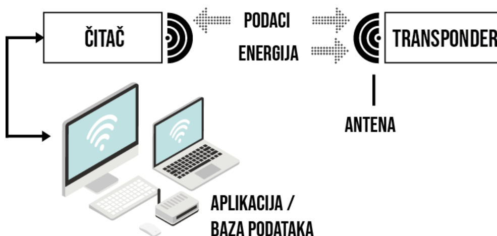
Slika 2.3. Primer funkcionisanja RFID sistema 7
