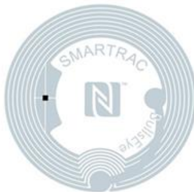
Slika 2.7. Primer izgleda 13,56 MHz NFC taga 11
