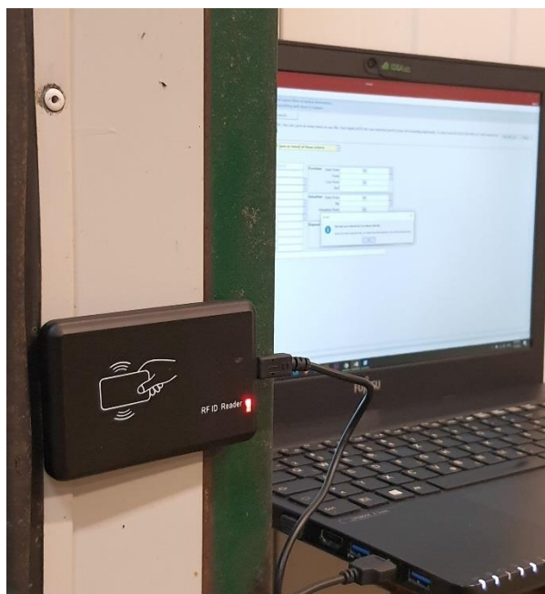
Slika 7.11. Očitavanje podataka na prelazu iz prijemnog skladišta u proizvodni pogon
