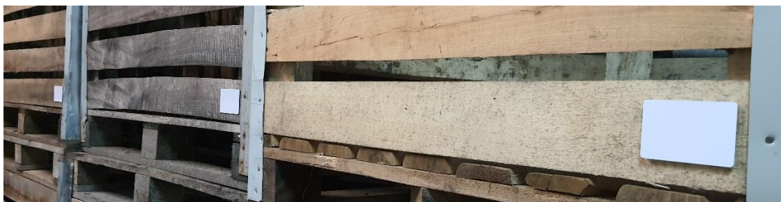
Slika 7.10. Boks palete u prijemnom skladištu označene sa HF tagovima
