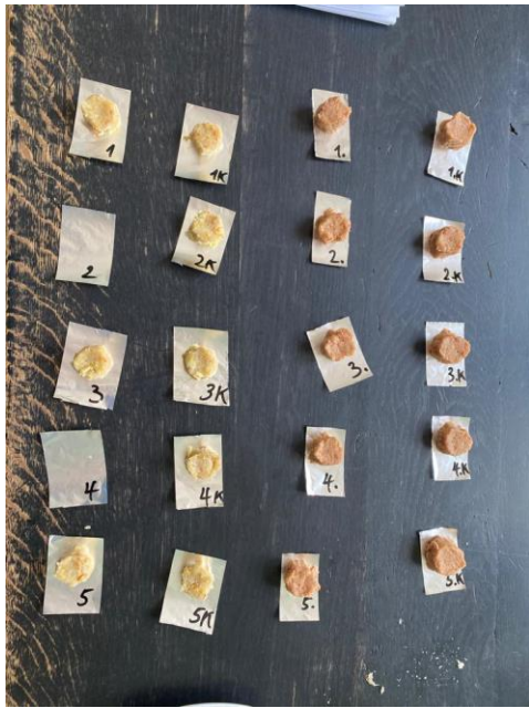
Слика 7.12: Изглед узорака за испитивање топлотне проводљивости и мерење температуре површине материјала
