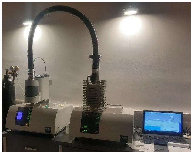
Слика 7.6.: Уређај NETZSCH STA449F5 Jupiter® за симултану термалну анализу материјала
