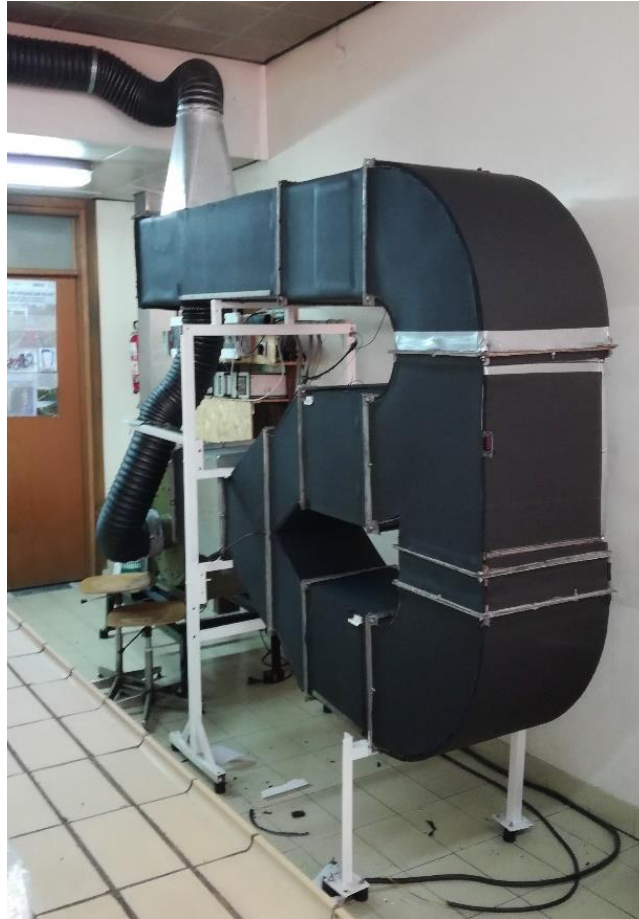
Слика 7.3: Лабораторијска сушара (Коморе за сушење)
