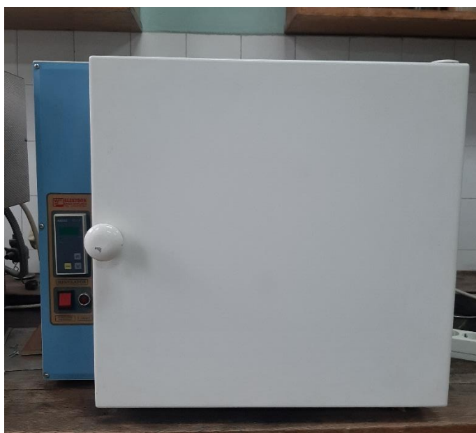
Слика 7.8: Лабораторијска пећ SU-4000 са терморегулацијом
