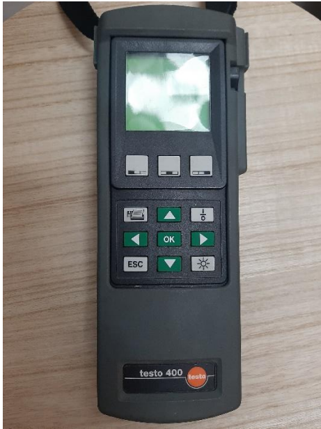
Слика 7.9: Уређај за мерење температуре Testo 400 са температурском сондом
