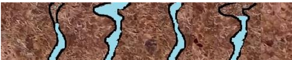
Слика 8.7: Прва фаза опадајуће брзине сушења воћног тропа
