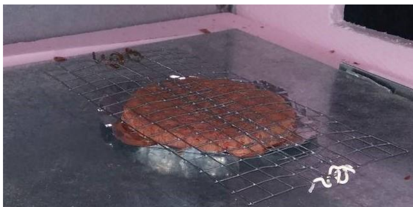
Слика 7.14: Осигуравање пријањања узорка на грејну подлогу коришћењем челичне мрежица
