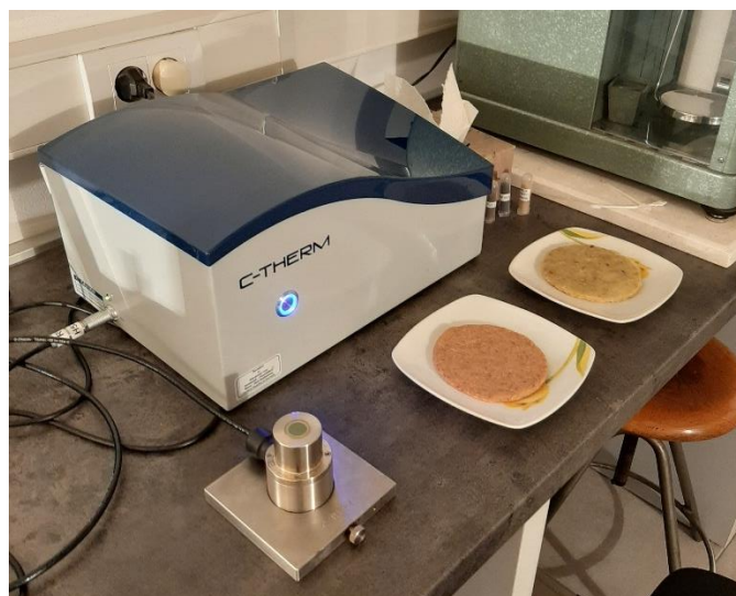
Слика 7.7 TCi уређај за испитивање топлотне проводљивости и ефузивности материјала
