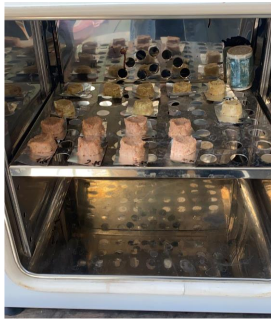
Слика 7.12: Изглед узорака за испитивање топлотне проводљивости и мерење температуре површине материјала
