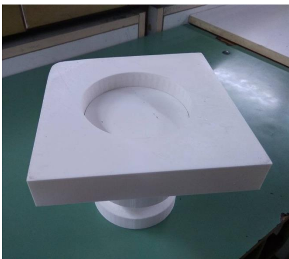
Слика 7.11: Припрема узорака за испитивање кинетике сушења
