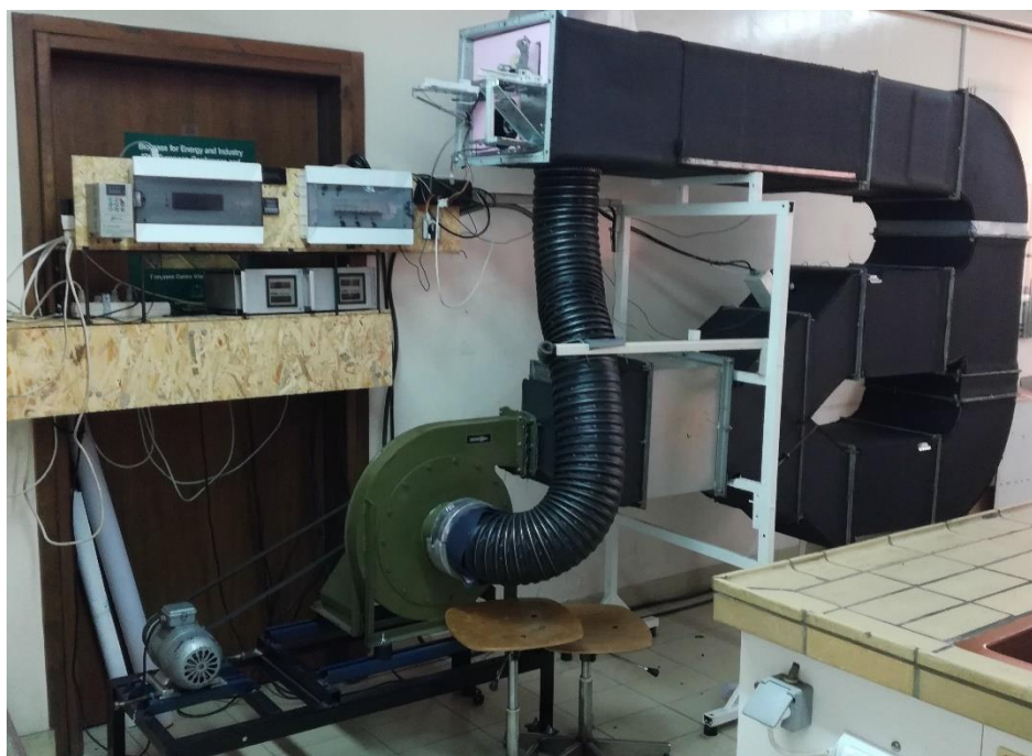
Слика 7.2: Лабораторијска сушара (управљачка јединица и електромотор са центрифугалним вентилатором)
