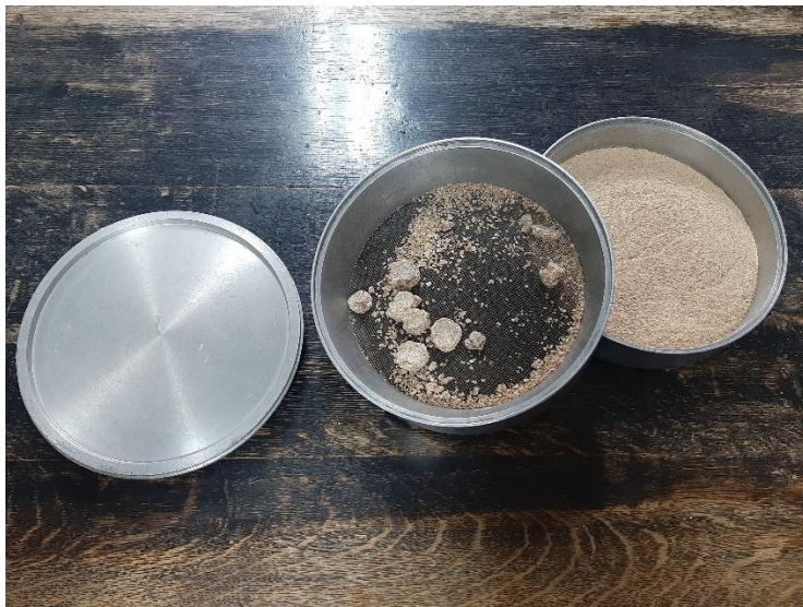
Слика 7.13: Припрема узорака за испитивање топлотне моћи
