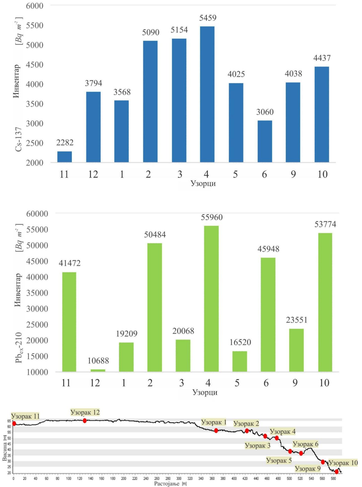
Слика 7.8. Расподела укупних инвентара ^{137}\text{Cs} (горњи панел) и ^{210}\text{Pb}_{\text{ex}} (средњи панел) у испитаним земљишним профилима са топографским профилем истраживаног подручја (доњи панел).
