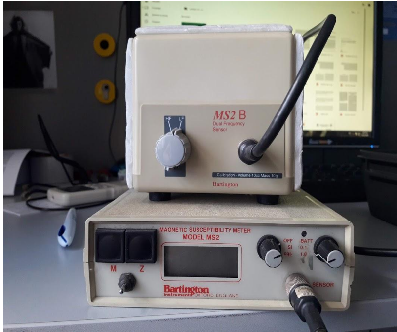
Слика 4.18. Делови кућишта и сензора мерног инструмента MS2, Bartington, (фотографија, К. Калкан, 2020).
