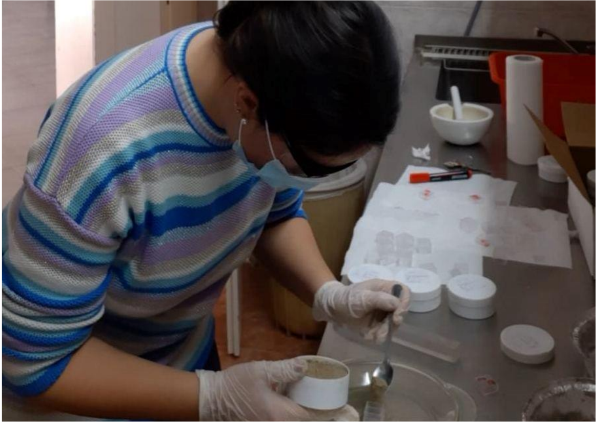
Слика 4.16. Припрема узорка за мерење магнетне суспектибилности, (фотографија, К. Калкан, 2020).
