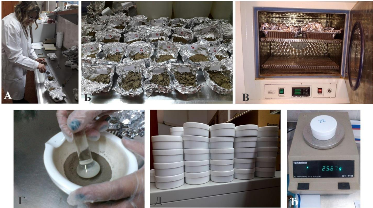
Слика 4.4. Припрема узорака за гама-спектрометрију: Сечење на слојеве од 1 cm (А), паковање у алумијумске кадице (Б), жарење у сушници (В), спрашивање узорака помоћу авана и тучка (Г), паковање узорка у мерне посуде (Д) и мерење масе узорака (Е), (фотографија, К. Калкан, 2017).
