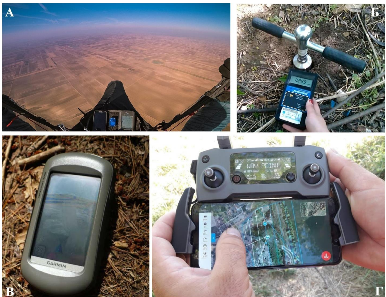
Слика 4.2. Опсервација Тителског лесног платоа параглајдер туром (А), мерење јачине амбијенталног еквивалента дозе из површинског слоја земљишта (Б), одређивање географских координата локација узорковања (В) и снимање терена дроном (Г), (фотографија, К. Калкан 2017).
