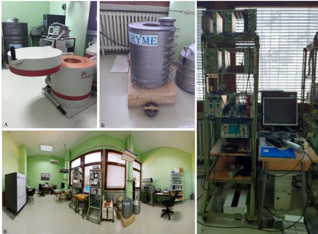
Слика 4.11. Гама-спектрометарски системи коришћени за одређивање садржаја радионуклида гама емитера: А) детектор Б - HPGe детектор типа GX10021, произвођача Canberra USA у фабричкој заштити од олова, Б) детектор L - HPGe детектор типа GMX, произвођача ORTEC, В) панорамски приказ лабораторије са детекторским системима у Лабораторији за испитивање радиоактивности узорка и дозе јонизујућег и нејонизујућег зрачења на Департману за физику, ПМФ-а у Новом Саду и Г) компоненте спектрометријског система (фотографија, К. Калкан, 2017).
