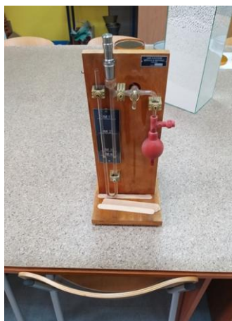
Сл. 67. Апаратура за испитивање специфичне површине згуре
