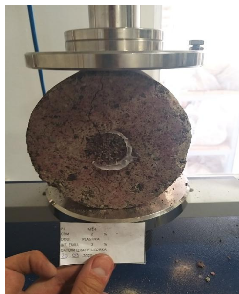
Сл. 92. Ломљење узорка (одређивање индијектне затезне чврстоће) на преси
