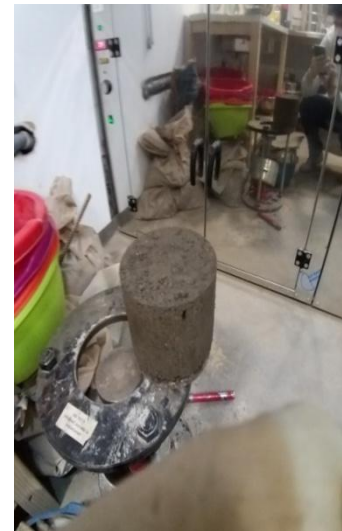
Сл. 80. Изглед набијеног узорка у калупу и вађење узорка из калупа помоћу екстрактора
