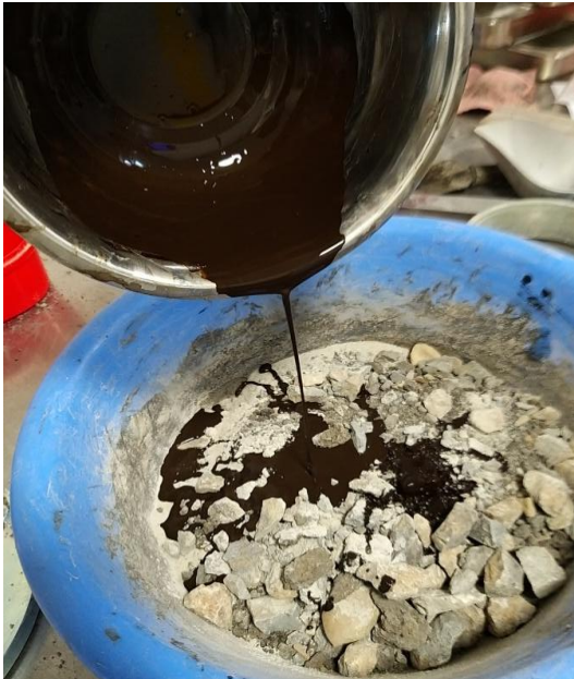
Сл. 79. Додавање емулзије мјешавини (лијево) и набијање мјешавине (десно)
