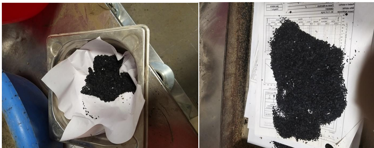
Сл. 69. Бакелит након загријавања на 60 °C и 110 °C
