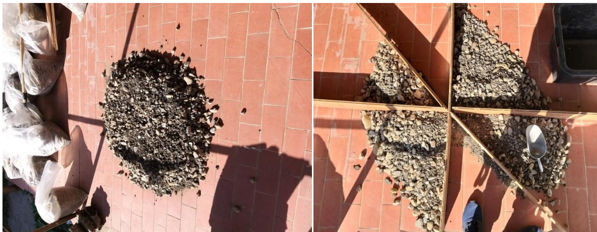
Сл. 64. Поступак четвртања и узимање репрезентативног узорка
