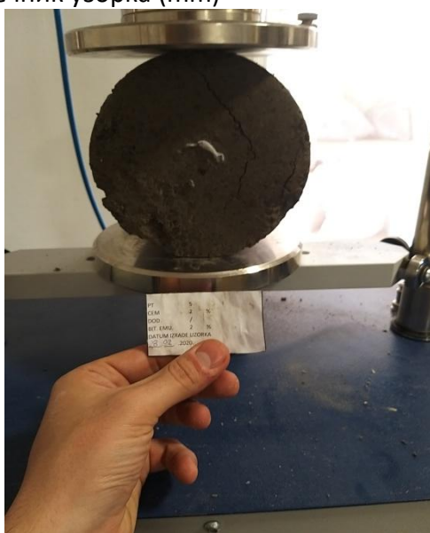
Сл. 92. Ломљење узорка (одређивање индијектне затезне чврстоће) на преси
