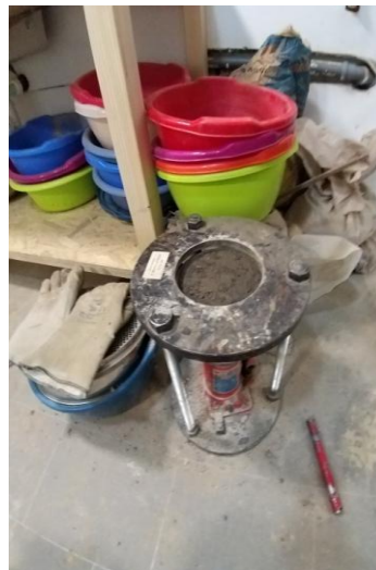
Сл. 80. Изглед набијеног узорка у калупу и вађење узорка из калупа помоћу екстрактора
