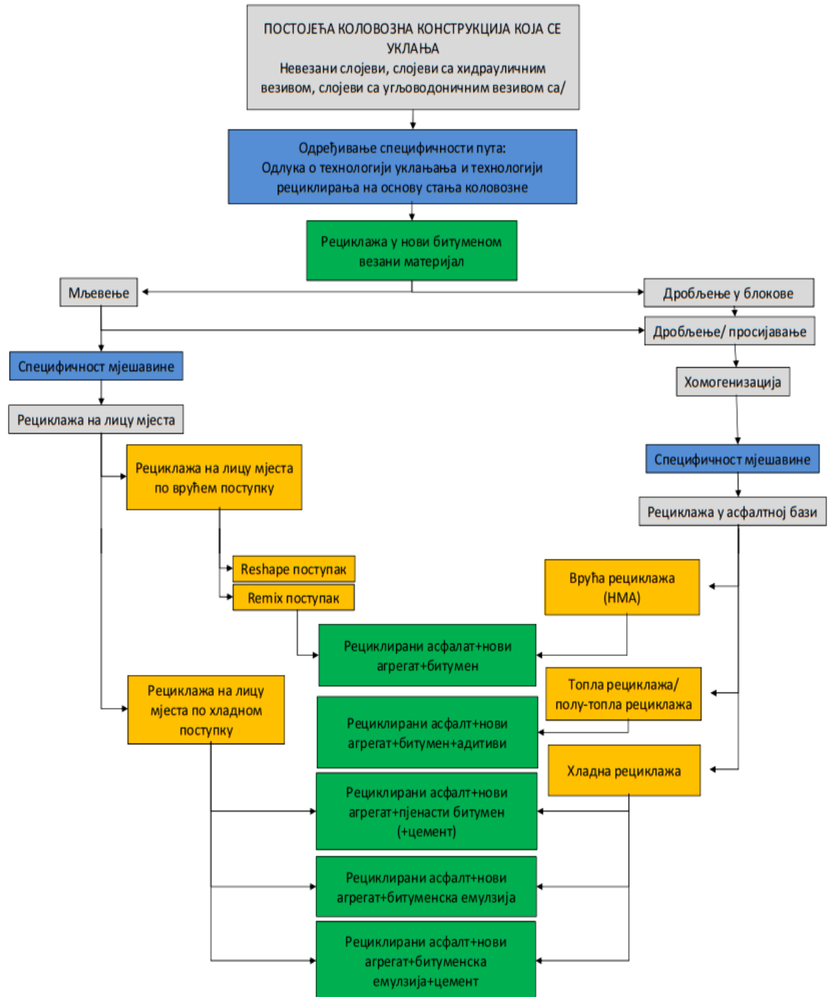
Сл. 14. Дијаграм техника за уклањање флексибилних коловозних конструкција, операција и рециклирања рециклираног асфалта [18]
