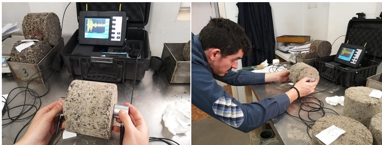
Сл. 93. Испитивање динамичког модула еластичности методом ултразвука
