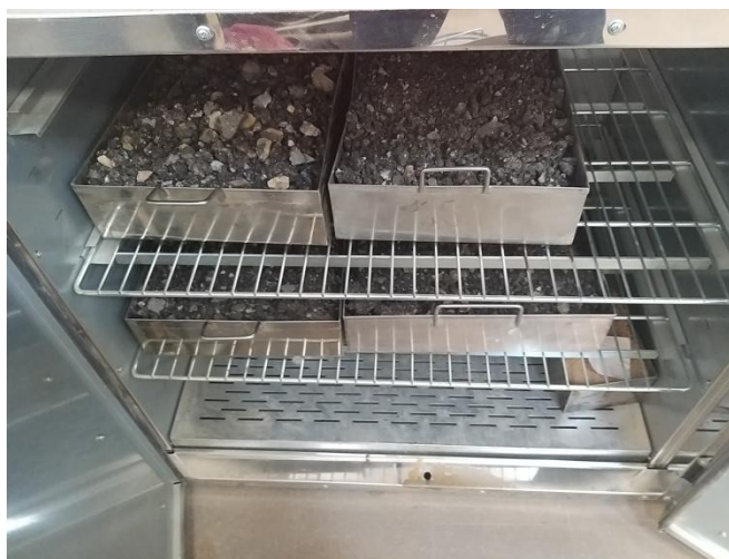
Сл. 63. Сушење репрезентативног узорка
