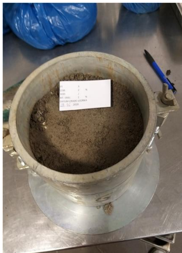
Сл. 80. Изглед набијеног узорка у калупу и вађење узорка из калупа помоћу екстрактора
