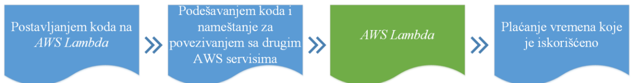
Slika 23 - Tok izvršavanja koda na AWS Lambda [94]
