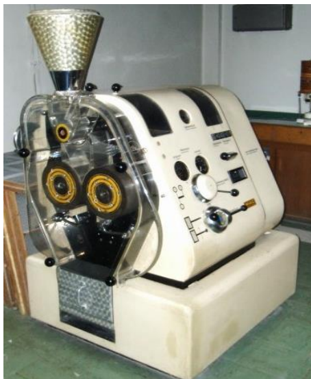
Slika 3.4. Laboratorijska valjna stolica – Variostühl C Ex 2 (Miag, Braunschweig, Germany)
