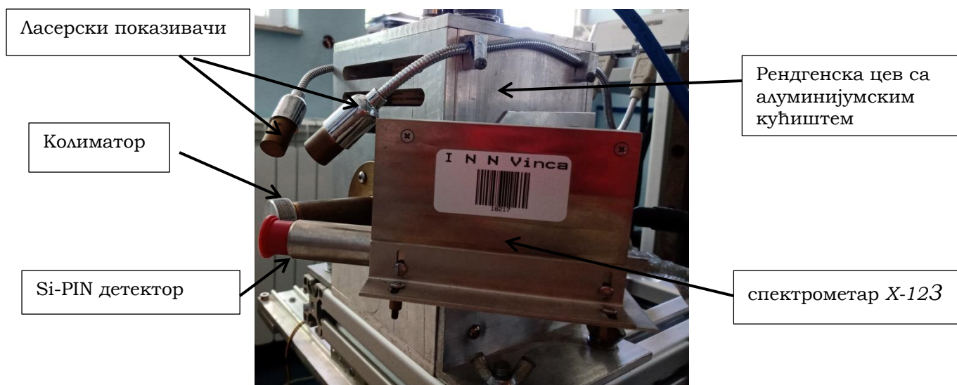
Слика 19. Фотографија преносног EDXRF спектрометра конструисаног у Институту Винча (поглед са стране)
