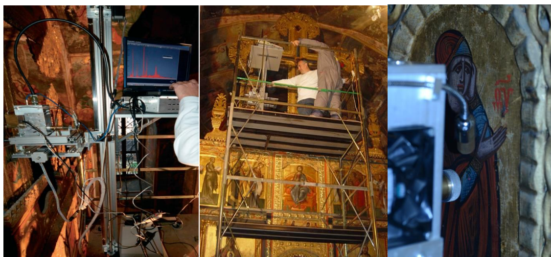
Слика 25. Фотографије снимљене приликом неструктурних испитивања које показују положаје преносног инструмента приликом мерења
