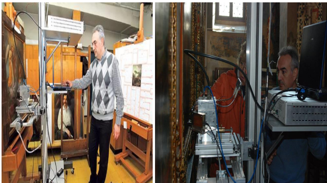
Слика 21. Фотографије преносног EDXRF спектрометра монтираног на модуларну покретну платформу приликом анализа слика и икона
