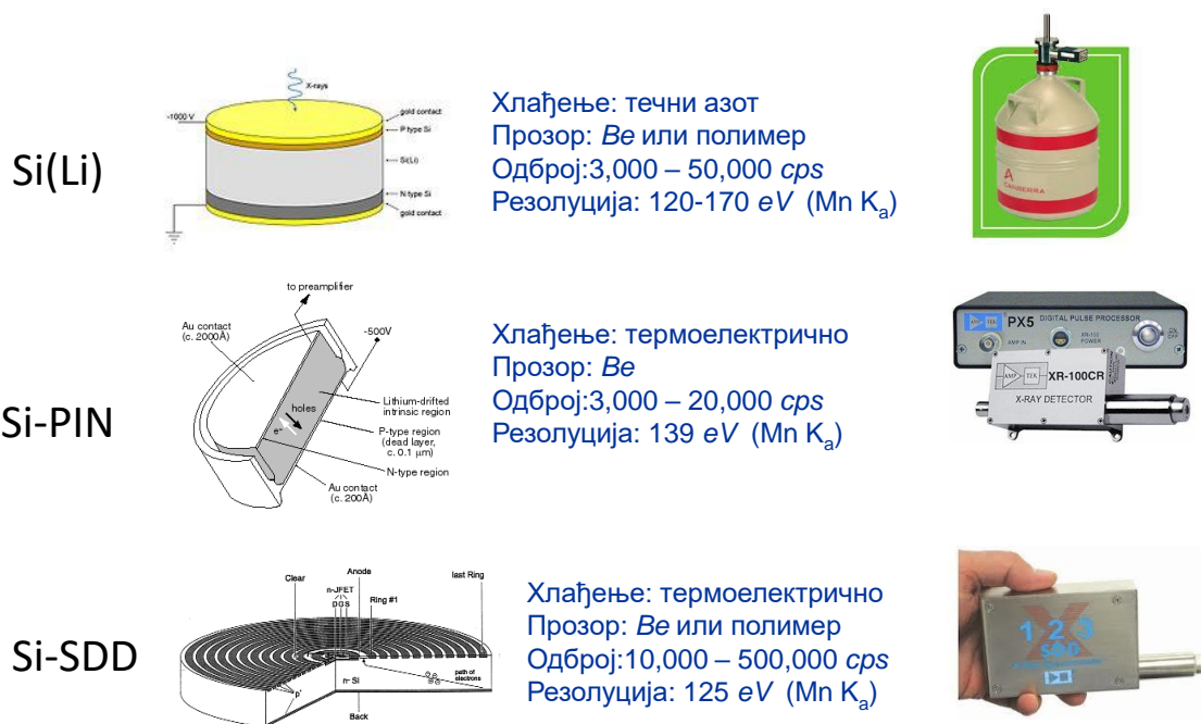
Слика 10. Приказ најчешће коришћених полупроводничких детектора X зрачења са карактеристикама (преузето са www.amptek.com )
