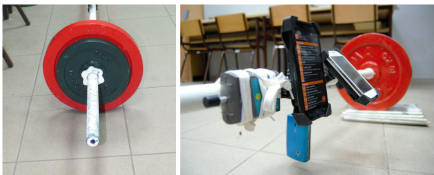
Слика 2.23: Плава тачка на стирани шипке је употребљена за праћење у Tracker-у. Vernier акцелерометар (везан за шипку) и Lenovo K6 паметни телефон (црни) били су примарни акцелерометри. Samsung Galaxy Core (бели) и Sony Ericsson Xperia Mini Pro (плави, окачен да висци) употребљени су за поређење. Укупна маса свих мерних уређаја је занемарљива у односу на масу шета. Слика претходно публикована у [1] ©European Physical Society. Reproduced by permission of IOP Publishing. All rights reserved.
