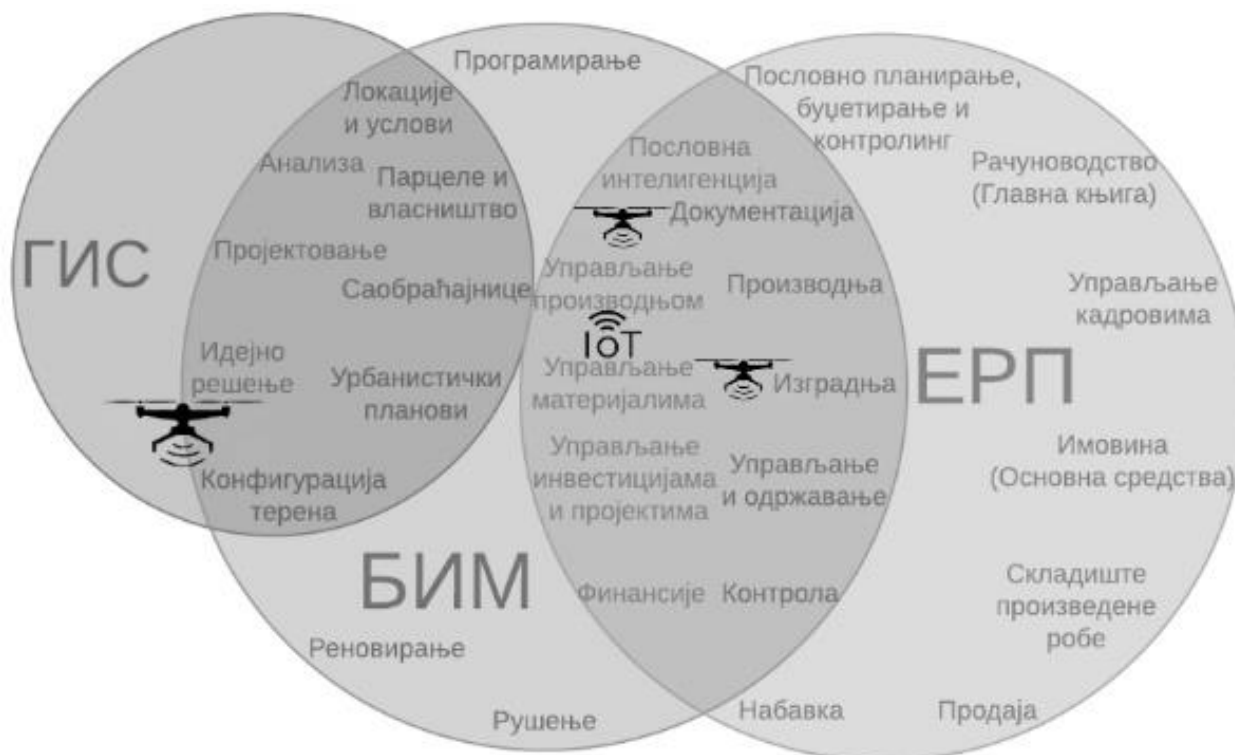
Слика 7.9. Предлог интеграције ЕРП и БИМ система уз коришћење ГИС алата, са употребом дронова и ИоТ-а
