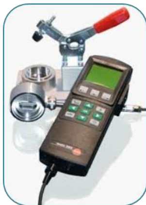
Slika 4.8. a_w metar Testo 650
