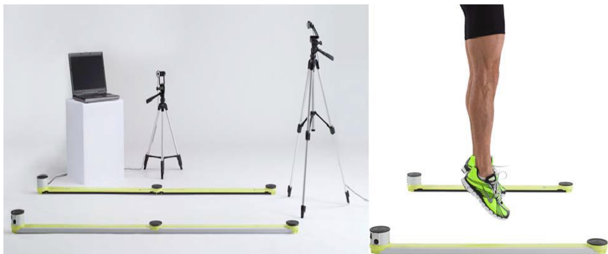
Слика 3. Optojump – оптички систем за мерење.
