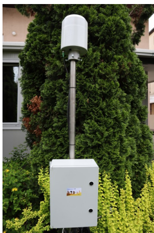
Прилог 8. Станица са ознаком 1xx опремљена са Lambrecht meteo rain[e] тежинским сензором
