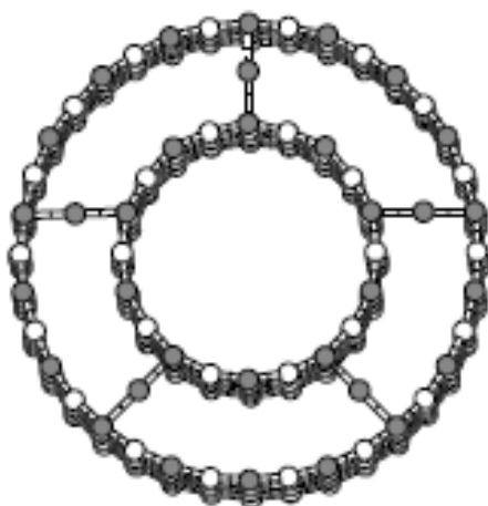
Slika 2.28. Šematski prikaz otvorene strukture dvoslojne ugljenične nanocevi koja je stabilizovana mostovima formiranim između unutrašnje i spoljašnje grafenske ploče [63]
