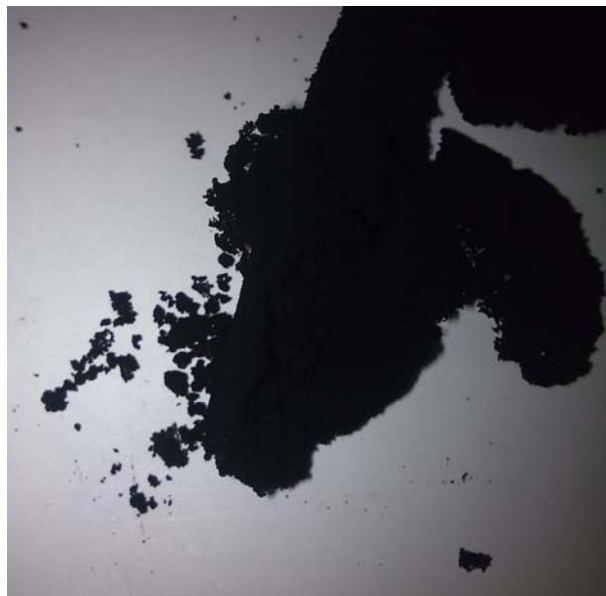
Slika 3.5. Izgled finalnog proizvoda sinteze UNC sintetisanog na 5Fe-Co-A katalizatoru
