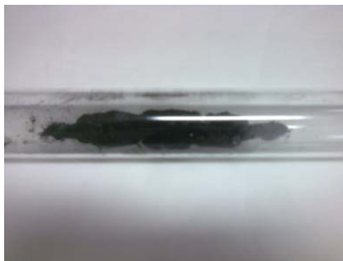
Slika 3.3. Izgled finalnog proizvoda sinteze UNC sintetisanog na 5Fe-S katalizatoru
