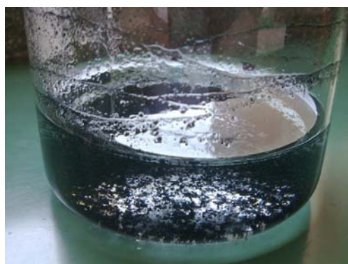
Slika 3.4. Izgled finalnog proizvoda sinteze UNC sintetisanog na 5Fe-S katalizatoru nakon tretmana 3M NaOH rastvorom
