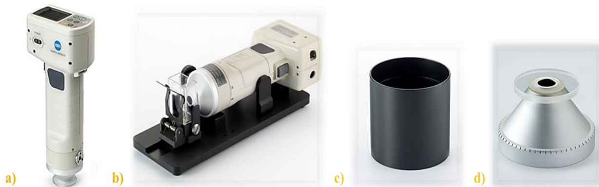
Slika 21. Instrumentalno merenje boje: a) merni instrument Minolta Chroma Meter CR-400; b) nastavak za merenje boje tečnih uzoraka (CR-A505, CM-A98); c) nastavak za merenje granuliranih materijala (CR-A50); d) nastavak sa staklenom zaštitom (CR-A33b)
