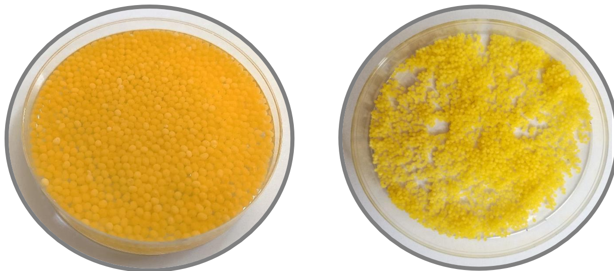
Slika 39. Izgled hidrogel i liofiliziranih čestica inkapsulata sporednog proizvoda prerade šargarepe dobijenog tehnikom elektrostatičke ekstruzije
