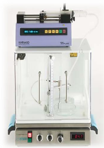
Slika 17. Elektrostatički sistem za inkapsulaciju, VAR V1 Nisco Encapsulation Unit
