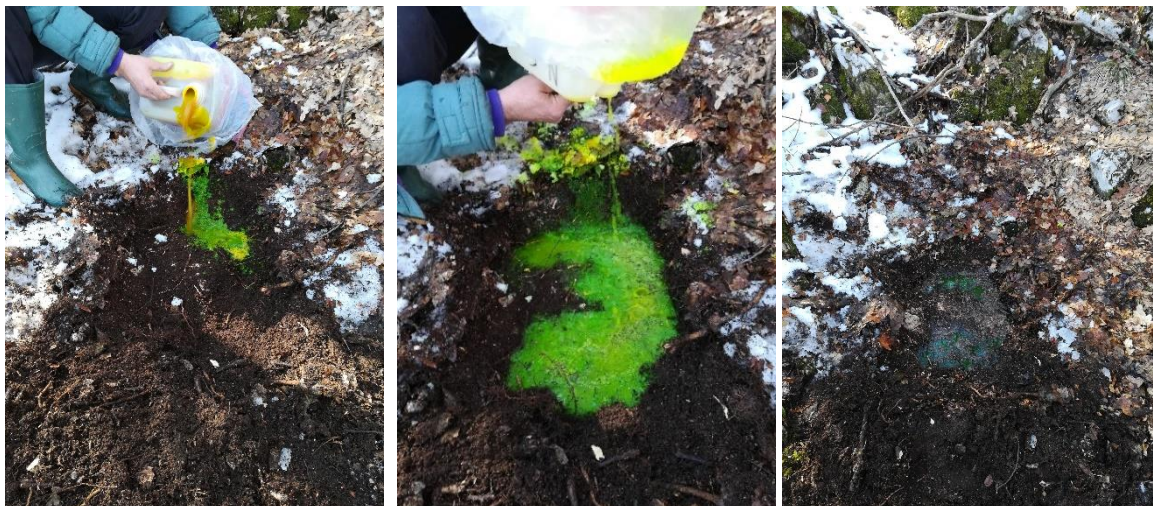
Slika 7.88. Nalivanje rastvora trasera na lokaciji iznad pećine, uz „ispiranje“ čistom vodom
