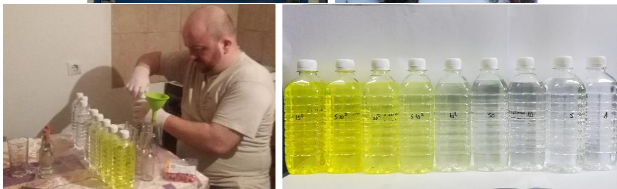
Slika 7.87. Priprema trasera za opit (gore) i „standarda“ za vizuelno osmatranje pojave trasera (dole)
