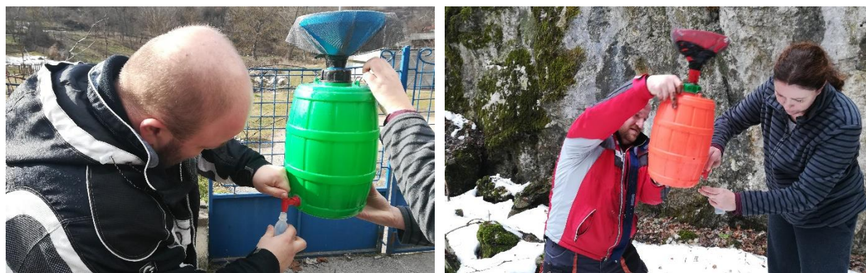
Slika 7.75. Uzorkovanje kišnice iz „RainCo“ kolektora na lokaciji Mokra (levo) i pećine Peč (desno)
