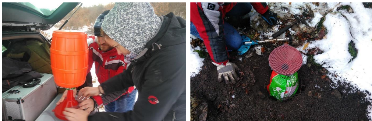
Slika 7.74. Priprema i instaliranje „RainCo“ kolektora na lokaciji pećine Peč
