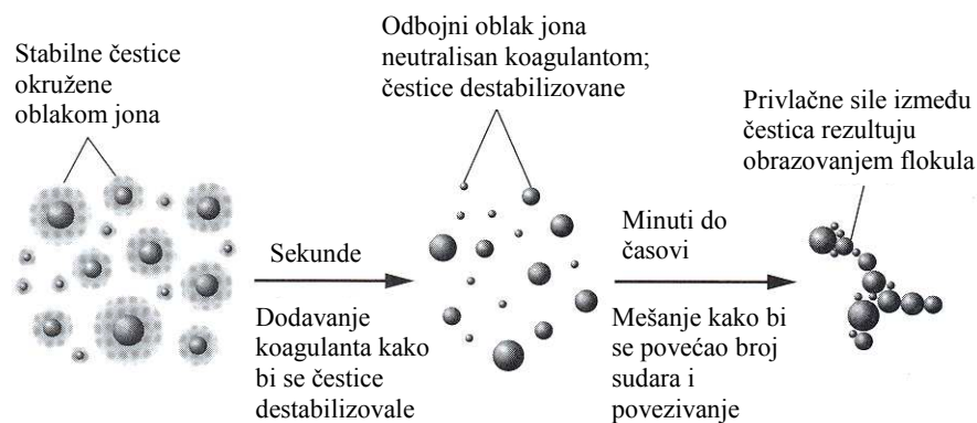
Slika 5. Šematski prikaz obrazovanja flokula (Crittenden et al., 2012)
