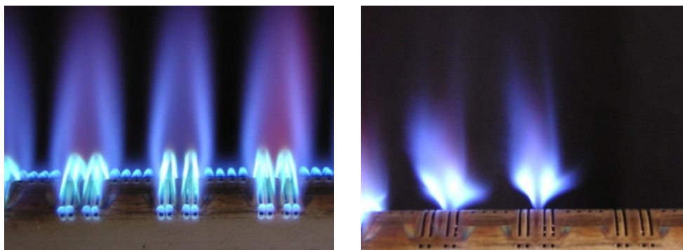
Slika 3.1 Fotografije rada atmosferskog gorionika; levo - metan (stabilan plamen), desno biogas (60% metan i 40% ugljen dioksid) (nestabilisan plamen) gde se vidi isticanje gorive smeše bez pojave plamena – oduvan plamen [45].
