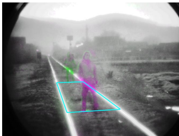
Slika 5.12 Lokacija Žitorađa: tačke za izračunavanje matrice homografije \mathbf{H} – sistem noćne vizije
