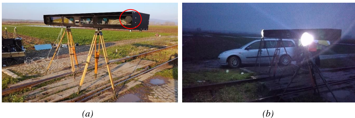
Slika 3.55 Postavljanje sistema na lokaciji Žitorađa – sistem noćne vizije: dnevni uslovi (a), noćni uslovi (b)
