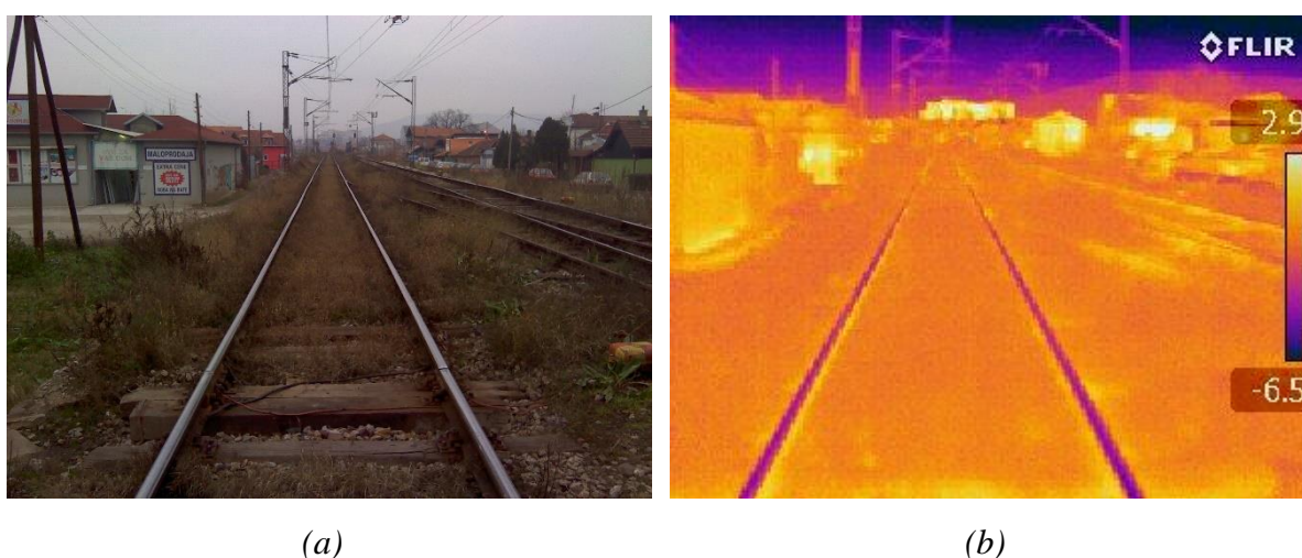
Slika 3.7 Snimanje termovizijskom kamerom FLIR E50 u dnevnim uslovima – lokacija u gusto naseljenom delu grada: digitalna slika (a), termogram (b)
