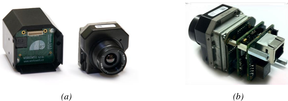
Slika 3.21 Termovizijska kamera i Workswell GigE adapter (a), sklop termovizijske kamere i adaptera (b) [216]
