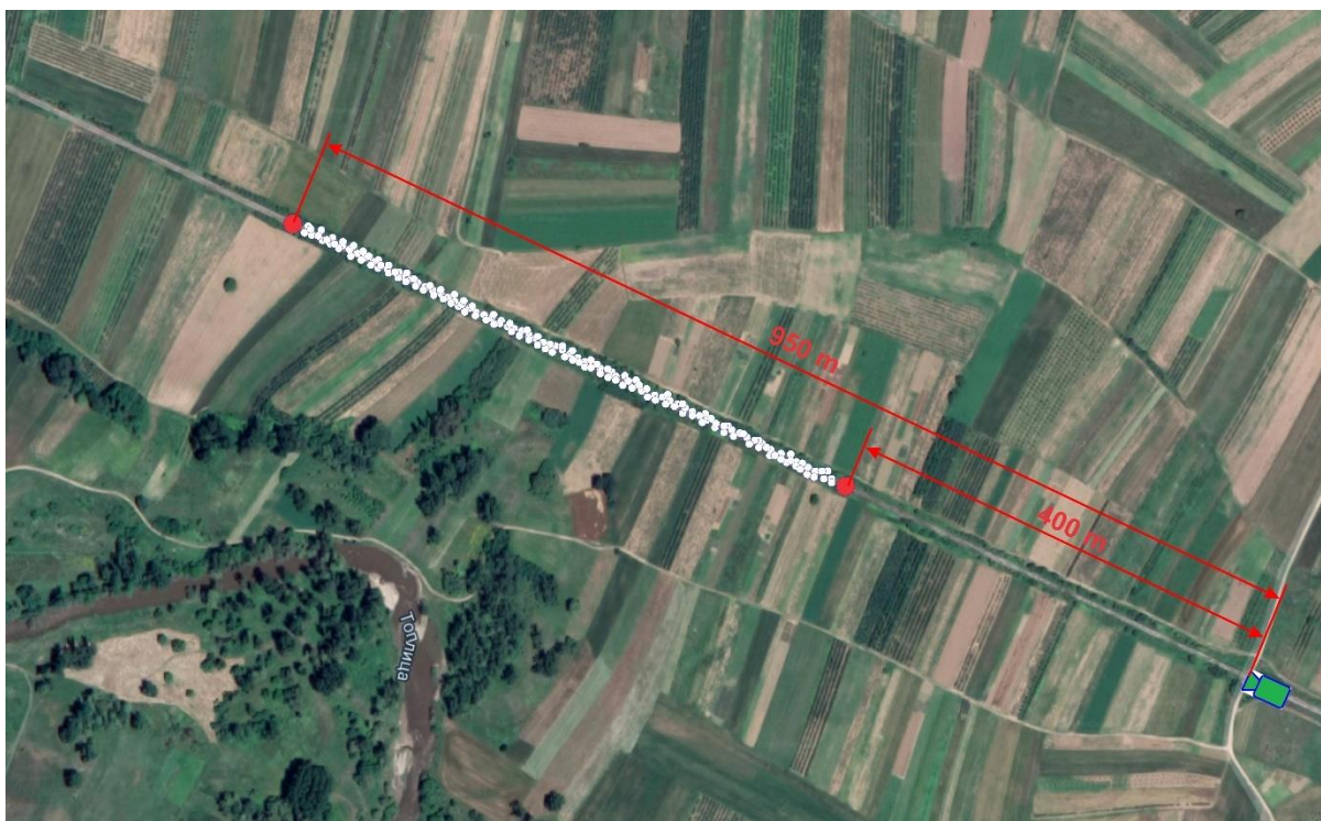
Slika 5.26 Ilustracija pozicija termovizijske kamere i objekata na koloseku na opsegu rastojanja od 400 do 950 metara
