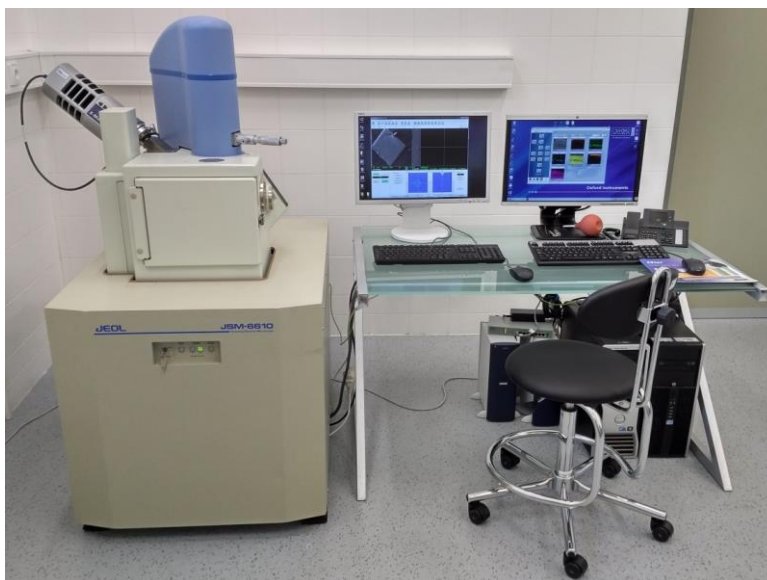
Slika 3.14. Skenirajući elektronski mikroskop JEOL JSM 6610LV
