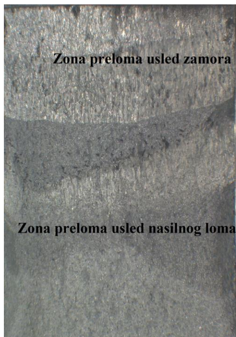
Slika 2.17. Izgled površine preloma usled zamora materijala
