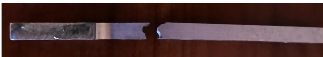
Slika 4.94. Lom epruvete na mestu zavara oko jezgra (parametri zavarivanja B-750/116)
