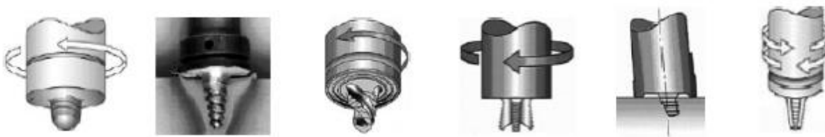
Slika 2.8. Oblici ZTM alata koje je razvio institut za zavarivanje TWI [29]
