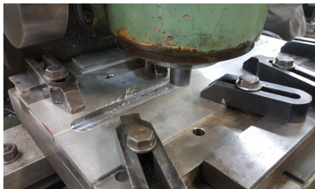
Slika 3.2. Primena alatne mašine – glodalice ALG-200 prilagođene za zavarivanje ploča postupkom trenjem sa mešanjem
