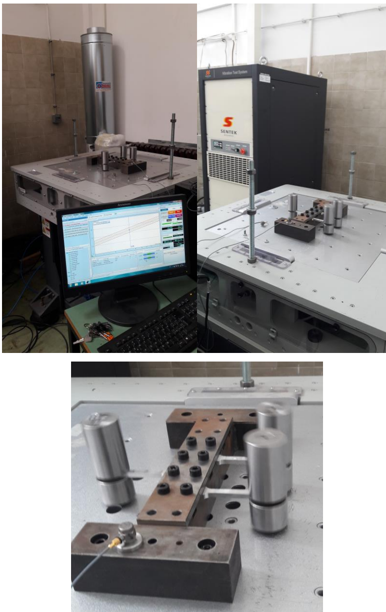
Slika 3.54. Elektro-dinamički vibracioni sto sa fiksatorom i istovremenom zamaranju 3 epruvete
