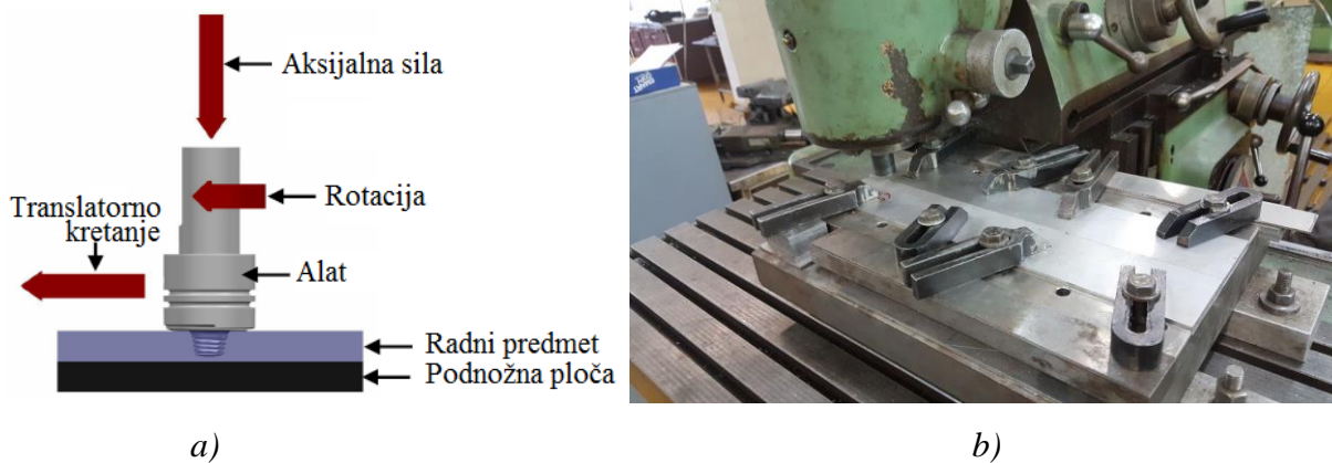
Slika 2.2. Šematski prikaz zavarivanja trenjem sa mešanjem (a) [23] i radni sto mašine sa fiksiranim radnim predmetima i podnožnom pločom (b)
