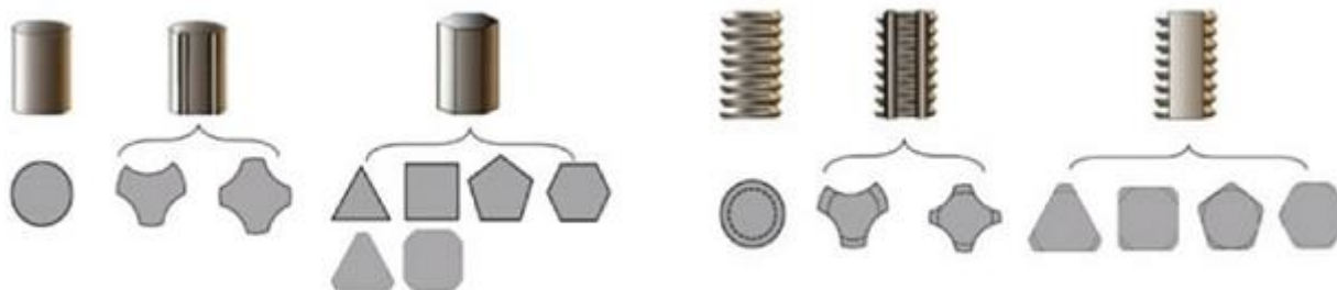
Slika 2.6. Oblici cilindričnih trnova bez navoja i sa urezanim navojem [29]
