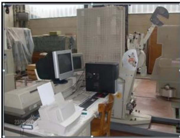
Slika 3.9. Instrumentirano Šarpijevo klatno Tinius Olsen nazivne energije 300 J
