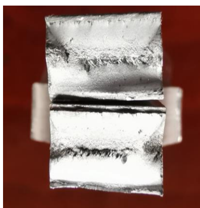
Slika 4.97. Prelomne površine zavarenog spoja (parametri zavarivanja A-750/73)
