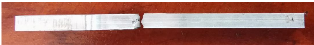
Slika 4.96. Lom epruvete na mestu zavara (parametri zavarivanja A-750/73)
