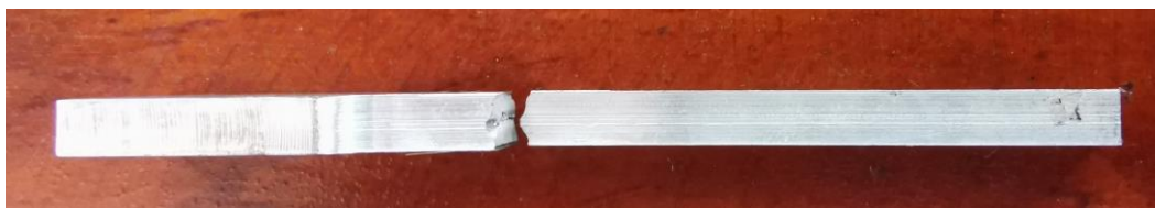
4.98. Lom epruvete na mestu zavora (parametri zavarivanja C-750/150)
