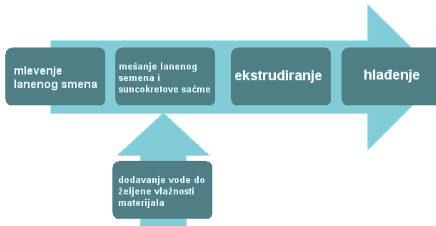
Slika 3.1 Šematski prikaz linije za proizvodnju funkcionalnog hraniva
