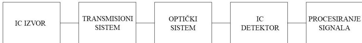
Slika 1. 2 Šematski prikaz infracrvenog spektrofotometra
