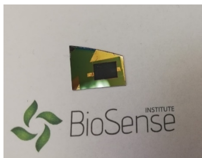
Slika 4. 11 Uzorak PbSe-I4, nakon tretmana u atmosferi joda i kiseonika
