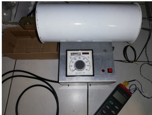
Slika 4. 8. Cevna peć za termičku senzitivizaciju uzoraka olovo selenida
