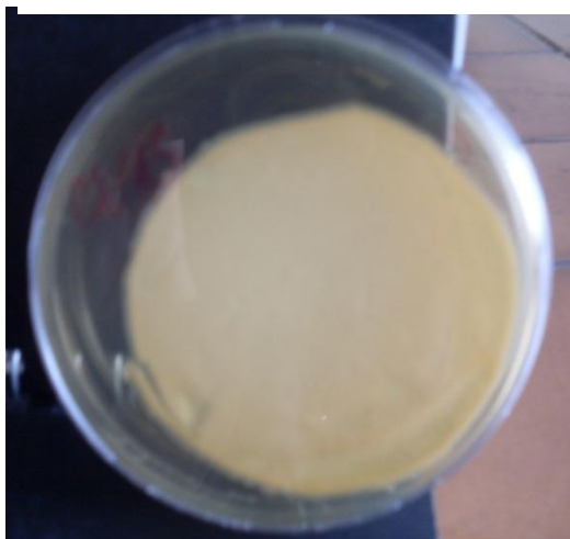
Slika 62. Odsustvo rasta E. coli sa filma i ploče za film sa 54 kg/m 3 voska
