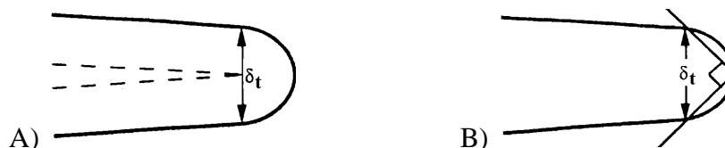
Slika 4.2. Definicije CTOD: a) rastojanje lica na mestu vrha prsline, b) presek sa otvorom 90° /4.2, 4.26/.
