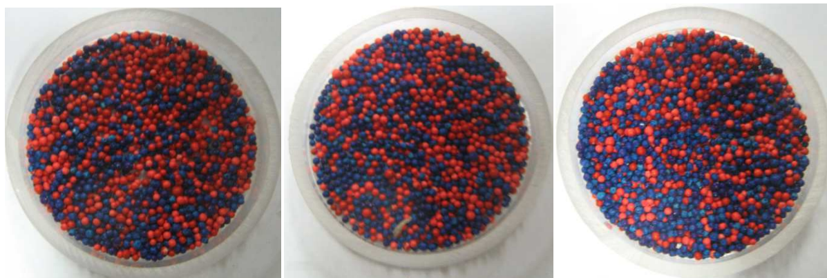
Slika 4.8. Eksperimentalni rezultati, slike preseka nakon prolaska materijala kroz mešalicu tipa Ross sa a) jednim elementom, b) sa dva elementa i c) sa tri elementa
