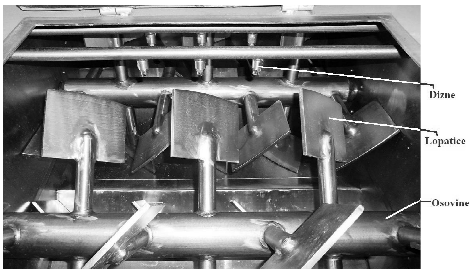
Slika 17. Dvoosovinska lopatasta mešalica (unutrašnjost) (model SLHSJ0.2, Muyang, Kina)
