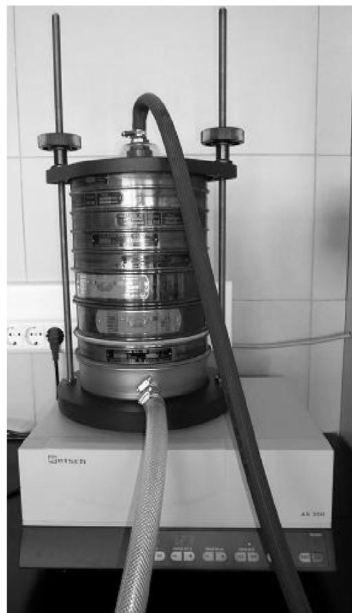
Slika 21. Sito tresilica sa dodatkom za mokro prosejavanje (Retsch AS 200 control, Haan, Nemačka)
