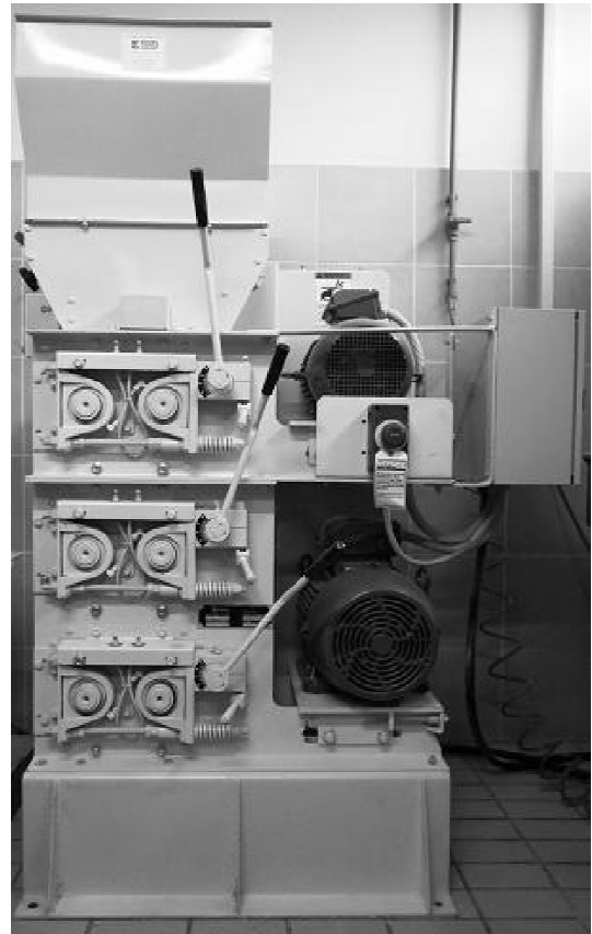
Slika 16. Mlin sa valjcima (ROSKAMP TP650-9, California pellet mill, SAD)
