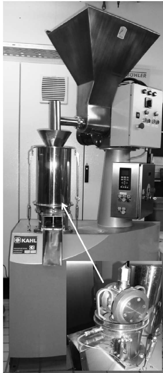
Slika 18. Pelet presa sa ravnom matricom (Amandus Kahl, model 14-175, Reinbek, Nemačka),
