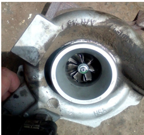
Slika 6.2. Prikaz oštećenih lopatica turbo punjača koje su izazvala sva ostala oštećenja
