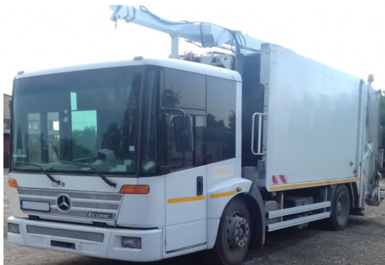
Slika. 5.3. Specijalno komunalno vozilo za prikupljanje smeća u kontejnerima 1.1 m 3 Izvor: arhiva JKP “Zelenilo”
